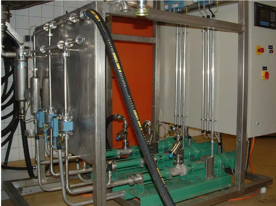
**Abbildung 2: Blick auf die 3 Dosierpumpen sowie die statischen Mischer und die Durchflussmesser**
