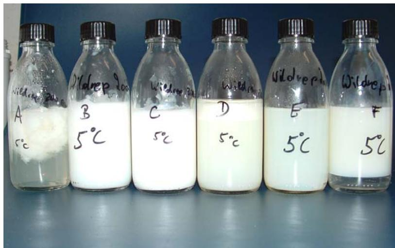
**Abbildung 1: Vergleich unterschiedlicher Formulierungen beim Kältestabilitätstest, bei Variante B und C ist keine Entmischung feststellbar**
