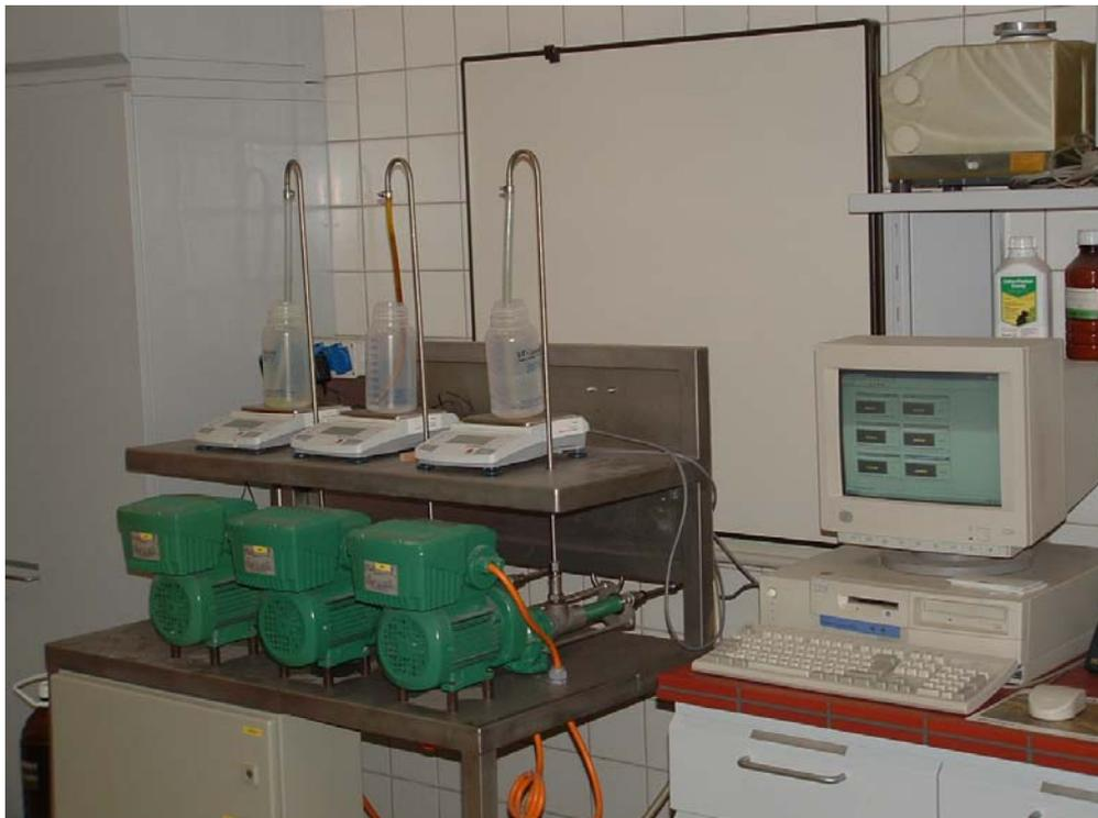
**Abbildung 3: Pilotanlage mit Messwerterfassungs-PC**
