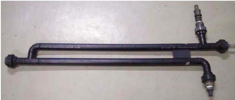
Abbildung 12: Vorrichtung zur Gaseinbringung in Flüssigkeiten - Gaseintragsystem
