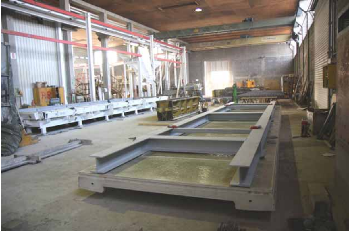
Im Produktionsablauf. Links Schalung der Wandelemente, Rechts fertiges Element mit Abheberahmen
