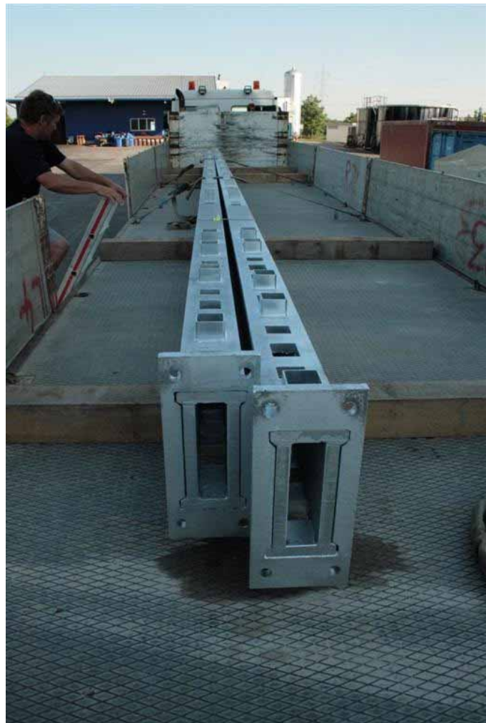
Vorspannkonsolen 11,5m lang, 2t schwer für 27 Vorspannkabel
