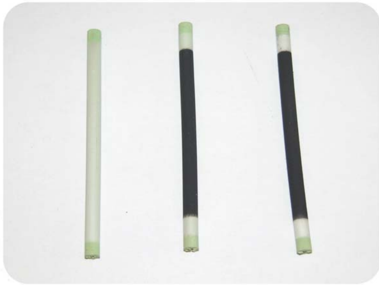
Abb.: Co-gesinterte NiO-YSZ/YSZ und NiO-YSZ/YSZ/LSM Röhrrchen. Quelle: Austrian Research Centers GmbH
