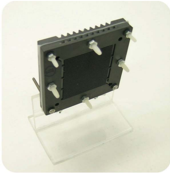
Abb.: PEM-Brennstoffzelle mit Komponenten aus Eigenfertigung. Quelle: FOTEC
