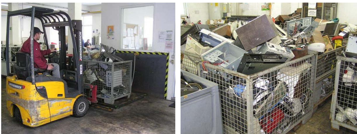
Abb. 6-2: Wiegung (links) und Zwischenlagerung (rechts) der Elektrokleingeräte
