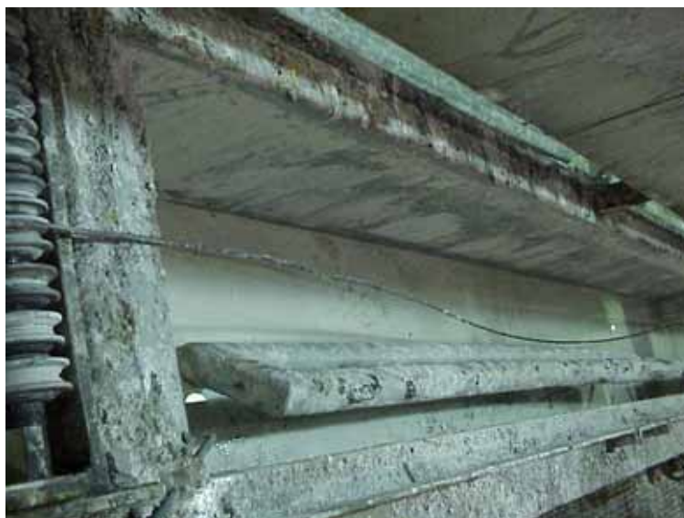
Abbildung 31: Patentieren 4 linke Seite, Phosphatbad vom Auslauf gesehen
