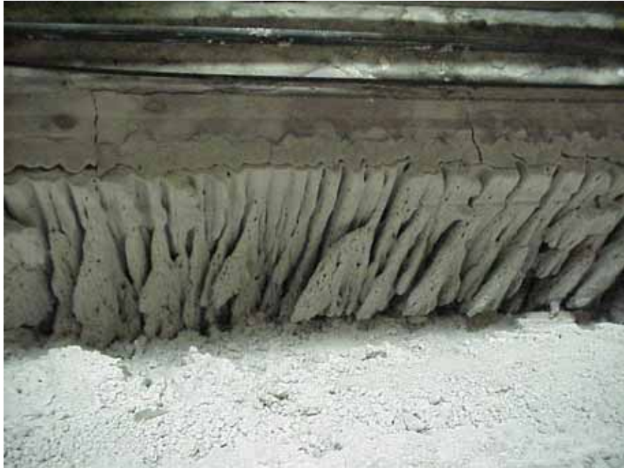
Abbildung 33: Patentieren 4; linkes Phosphatbad; vor Reinigung; Ablagerungen an nicht beheizter Wand
