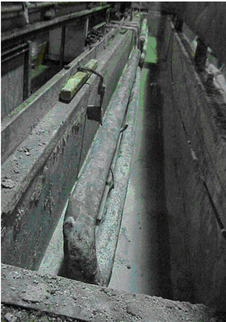
Abbildung 28 : Patentieren 4 rechte Seite, Phosphatbad vom Auslauf gesehen
