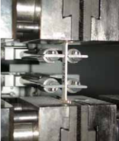
Abb. 59: Universalprüfmaschine mit eingespannter Zugprobe
