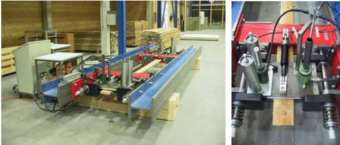
Abb.13: Zugprüfanlage GEZU 850 und Detail der Einspannbacken
