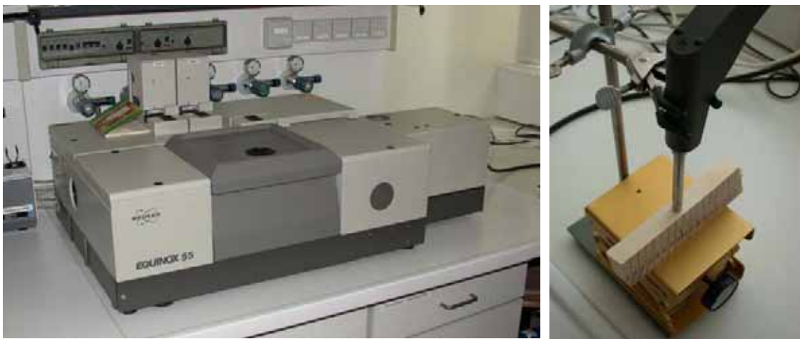
Abb. 51: FT-IR Spektrometer Equinox 55 (links) der Firma Bruker mit einer Faseroptiksonde (rechts) für das nahe Infrarot
