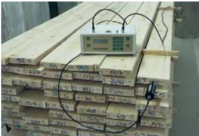
Abb. 12: Ultraschallmessgerät Sylvatest (links) und Konusschallkopf (rechts)
