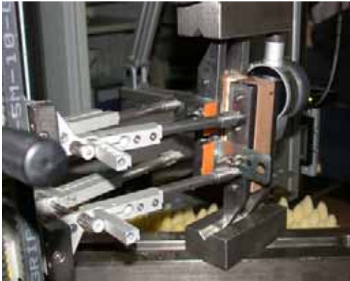
Abb. 57: Universalprüfmaschine mit eingespannter Scherprobe
