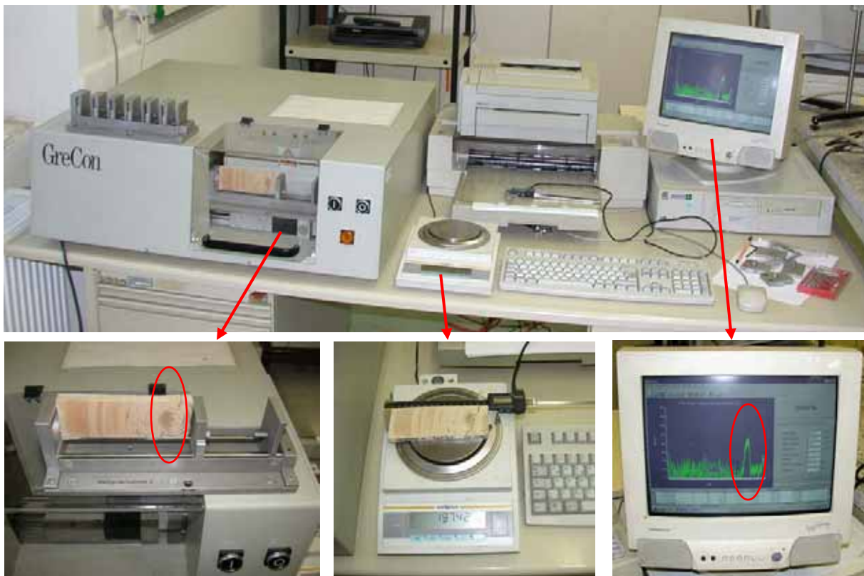
Abb 42: Messung der Dichte mit Hilfe eines Röntgen-Messgerätes
