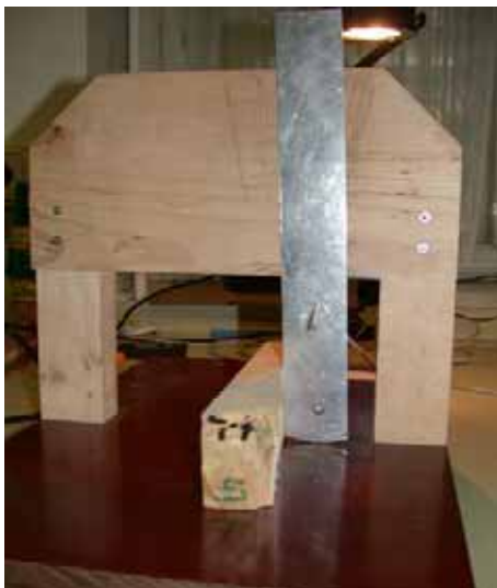
Abb. 45: Messanordnung zur Drehwuchsmessung
