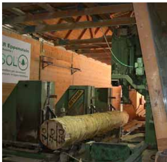
Abb. 5: Erster Einschnitt zum Abtrennen der Seitenware
