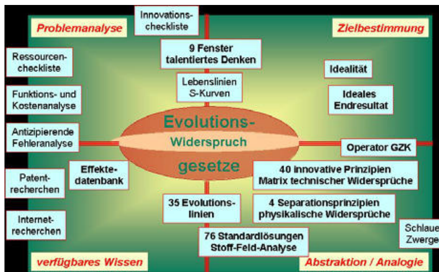
Abbildung 21: Elemente der TRIZ Methode gegliedert nach den Kategorien Problemanalyse, Zielbestimmung, Lösungsfindung durch Anwendung verfügbaren Wissens und Lösungsfindung durch Abstraktion und Analogie
