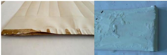
Backsheets nach Damp Heat Test
