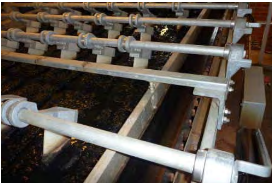
Abbildung 128: Siebpresse zur Entfeuchtung des Klärschlammes (Quelle: New Energy)
