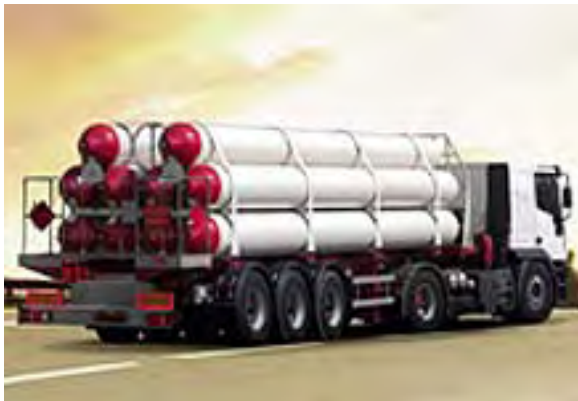
Abbildung 41: Transportsystem auf Basis der Röhrenspeicher von Tenaris (Quelle: Tenaris)
