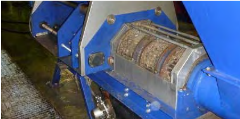
Abbildung 123: Schraubenpresse zur Erzeugung von biogenem Brei in Eskilstuna (Quelle: New Energy)
