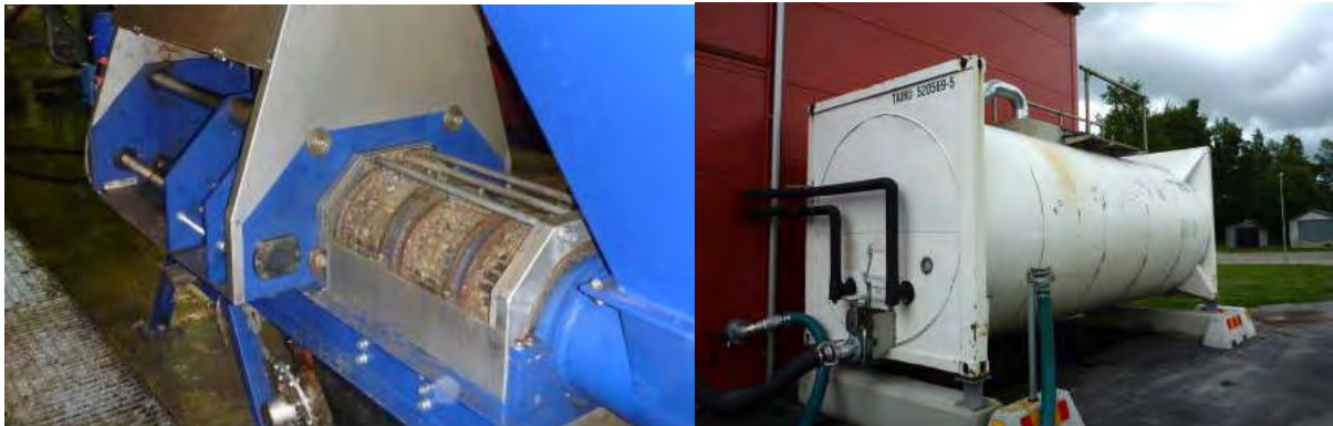
Abbildung 6: Schraubenpresse der Aufbereitungsanlage in Eskilstuna (links); Beschickung des Kläranlagenfermenters mit dem produzierten biogenen Brei (rechts) (Quelle: New Energy)
