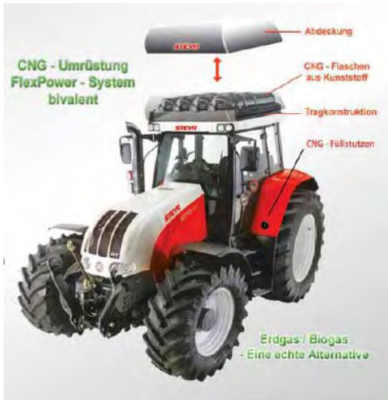
Abbildung 82: Umrüstung eines Traktors Steyr CVT 6195 auf Mischbetrieb Biogas/Erdgas - Diesel (Quelle: LuPower)
