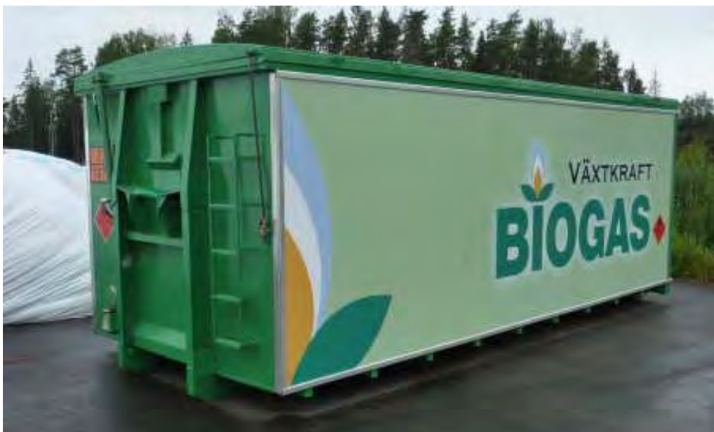
Abbildung 102: Biogas-Container zur Versorgung der Insel-tankstelle (Quelle: New Energy)
