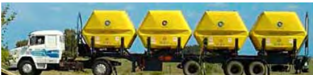
Abbildung 42: Transportlösung "Gasoducto Virtual" von Galileo (Quelle: Galileo)
