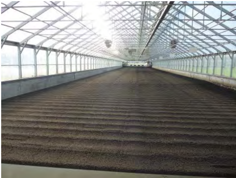
Abbildung 148: Solare Trocknungshalle für Klärschlamm (Quelle: New Energy)
