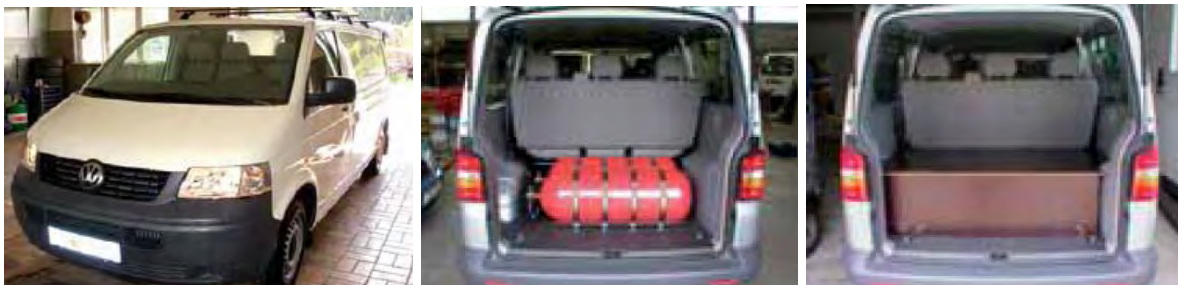
Abbildung 81: Beispiel für Umrüstung von Benzin auf Erdgas/Biogas: VW T5 Kastenwagen (Quelle: LuPower)
