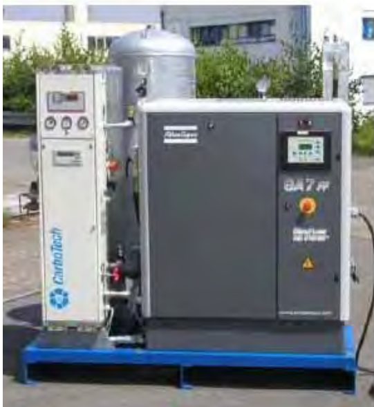
Abbildung 139: Stickstoffproduktionsanlage (CARBO TECH ENGINEERING GMBH 2008)
