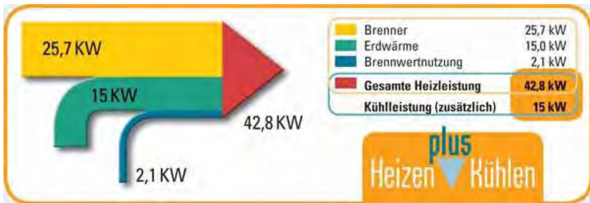
Abbildung 100: Energieflussdiagramm der Helioplus-Hybridheizung
