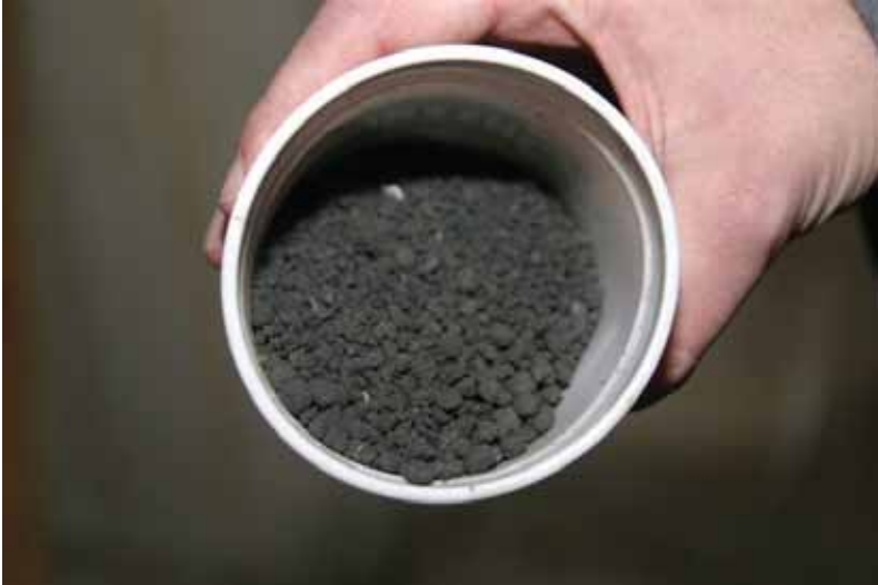
Abbildung 12: Endprodukt der Klärschlamm-trocknung
