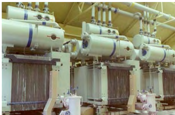
Abbildung 2: Marktgängige Elektrolyseure zur Wasserstofferzeugung (Quelle: Wasserelektrolyse Hydrotechnik GmbH)
