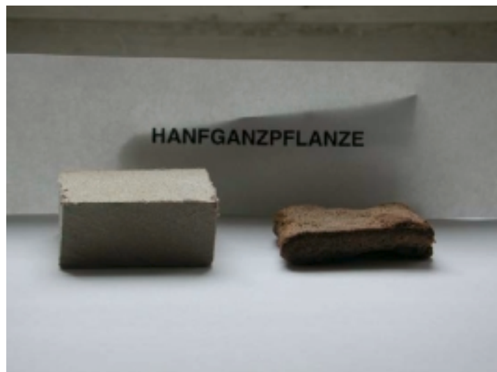
Abb. 25: Veränderung des Werkstoffes HG-R nach 6-monatiger Kompostierung (rechts) im Vergleich zur Ausgangsprobe (links)
