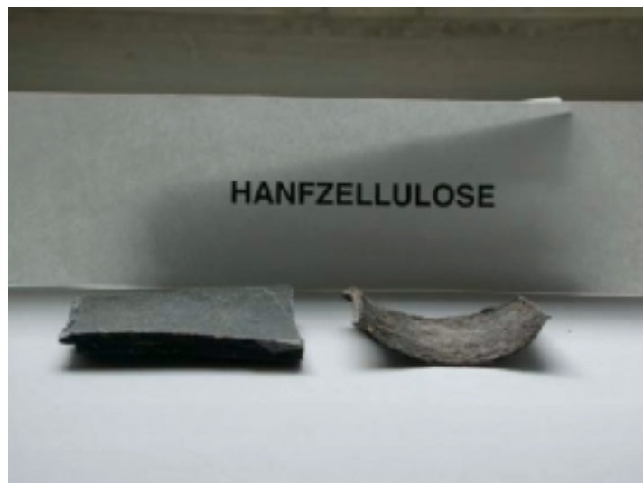
Abb. 26: Veränderung des Werkstoffes HZ-R nach 6-monatiger Kompostierung (rechts) im Vergleich zur Ausgangsprobe (links)
