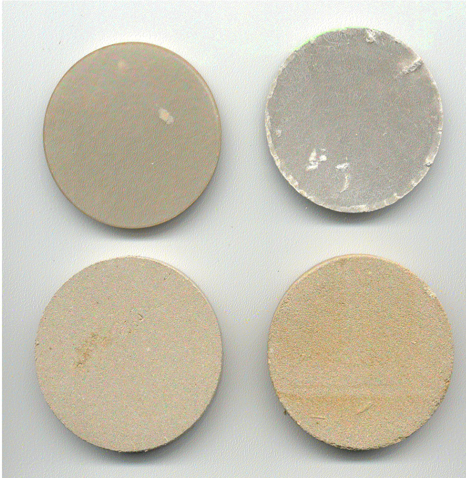
Abb. 43: Oben: ZELFO-HZ vor und nach der zwölfstündigen Wasserlagerung Unten: ZELFO-HG vor und nach der zwölfstündigen Wasserlagerung
