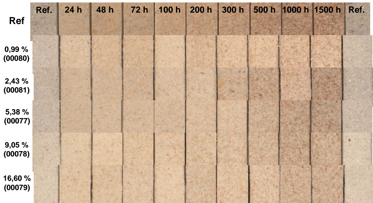
Abb. 8.1.2.2.4: Oberflächen der mit Titandioxid modifizierten Zelfo HRS-Probekörper in Abhängigkeit der Bewitterungsdauer
