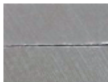
Abb. 8.1.2.3.1: Oberflächen der unmodifizierten Zelfo HZ-Probekörper (unten: Referenz, oben: 1500 h bewittert)
