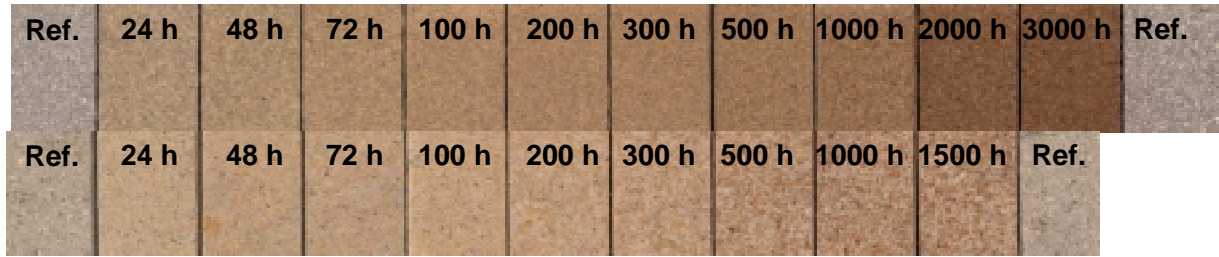
Abb. 8.1.2.1.3: Oberflächen der Zelfo HG- (oben) und der Zelfo HRS-Probekörper (unten) in Abhängigkeit der Bewitterungsdauer
