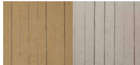
Abbildung: Farbänderung von WPC-Proben während der Bewitterung, sowie Prüfkörper vor und nach der 4 wöchigen QUV-Bewitterung. Links: WPC aus 70% acetylierten Fichtenholzspänen, 2% HV1, 1,5% UV-Additiv, 26,5% PP. Rechts: WPC aus 70% gemischt acylierten Fichtenholzspänen, 2% HV1, 28% PP.
