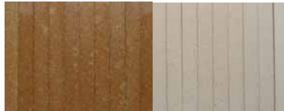
Abbildung: Farbänderung von WPC-Proben während der Bewitterung, sowie Prüfkörper vor und nach der 4 wöchigen QUV-Bewitterung: WPC aus 50% gemischt acylierten Fichtenholzspänen, 2% HV1, 48% PP.
