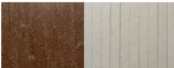
Abbildung: Farbänderung von WPC-Proben während der Bewitterung, sowie Prüfkörper vor und nach der 4 wöchigen QUV-Bewitterung. Links: WPC aus 50% acetylierten Fichtenholzspänen, 2% HV1, 48% PP. Rechts: WPC aus 50% acetylierten Fichtenholzspänen, 2% HV1, 1,5% UV Schutz, 46,5% PP.
