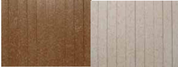
Abbildung: Farbänderung von WPC-Proben während der Bewitterung, sowie Prüfkörper vor und nach der 4 wöchigen QUV-Bewitterung. Links: WPC aus 50% Fichtenholzspänen, 2% HV1, 48% PP. Rechts: WPC aus 50% Fichtenholzspänen, 2% HV1, 1,5% UV Schutz, 46,5% PP.
