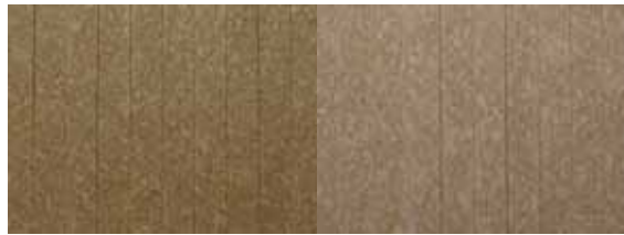
Abbildung: Farbänderung von WPC-Proben während der Bewitterung, sowie Prüfkörper vor und nach der 4 wöchigen QUV-Bewitterung. Links: WPC aus 50% acetylierten Buchenholzspänen, 2% HV1, 48% PP. Rechts: WPC aus 50% acetylierten Buchenholzspänen, 2% HV1, 1,5% UV Schutz, 46,5% PP.
