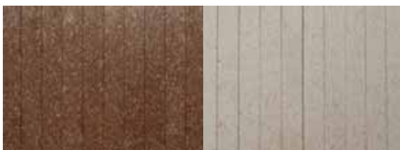
Abbildung: Farbänderung von WPC-Proben während der Bewitterung, sowie Prüfkörper vor und nach der 4 wöchigen QUV-Bewitterung. Links: WPC aus 50% Buchenholzspänen, 2% HV1, 48% PP. Rechts: WPC aus 50% Buchenholzspänen, 2% HV1, 1,5% UV Schutz, 46,5% PP.
