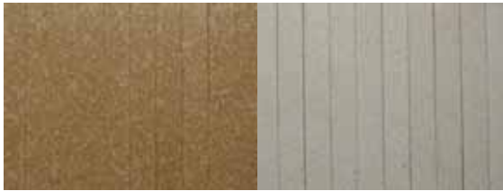
Abbildung: Farbänderung von WPC-Proben während der Bewitterung, sowie Prüfkörper vor und nach der 4 wöchigen QUV-Bewitterung. Links: WPC aus 50% acetylierten Buchenholzspänen, 2% HV1, 48% PP. Rechts: WPC aus 50% acetylierten Buchenholzspänen, 2% HV1, 1,5% UV Schutz, 46,5% PP.
