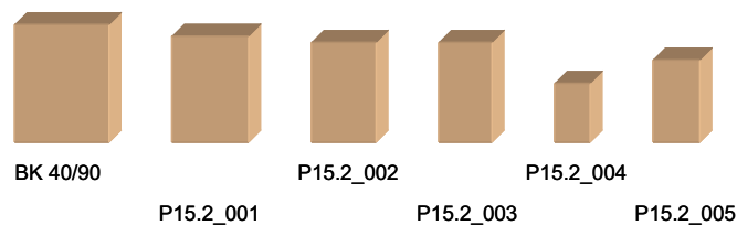
Abb.43: Änderung der Spangeometrie bei den WPC-Profilen der Gruppe 1
