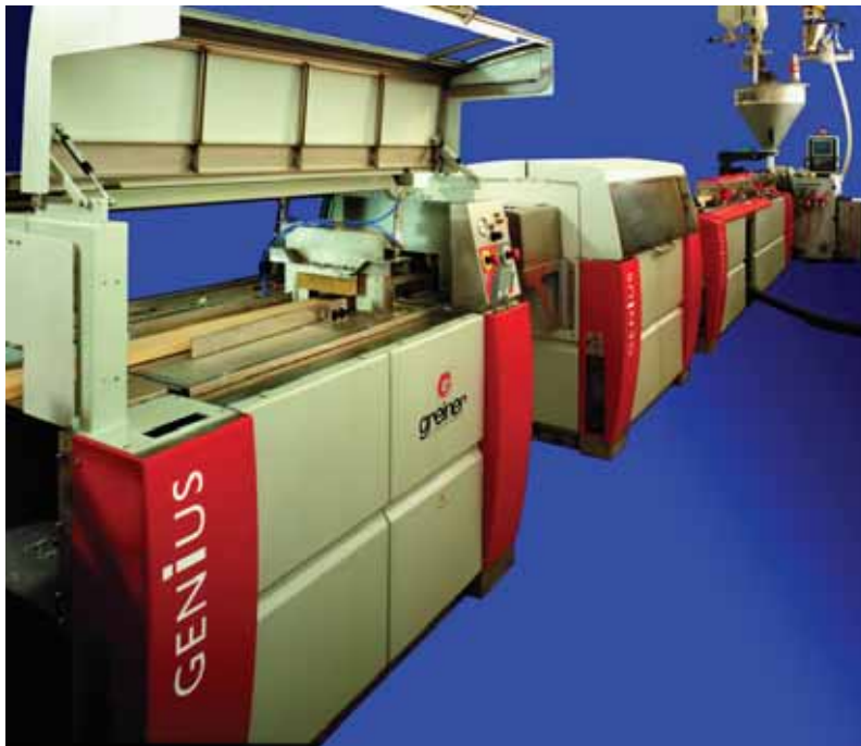
Abb. 56: Extrusionslinie mit Säge, Abzug, Kalibriertank und Extruder
