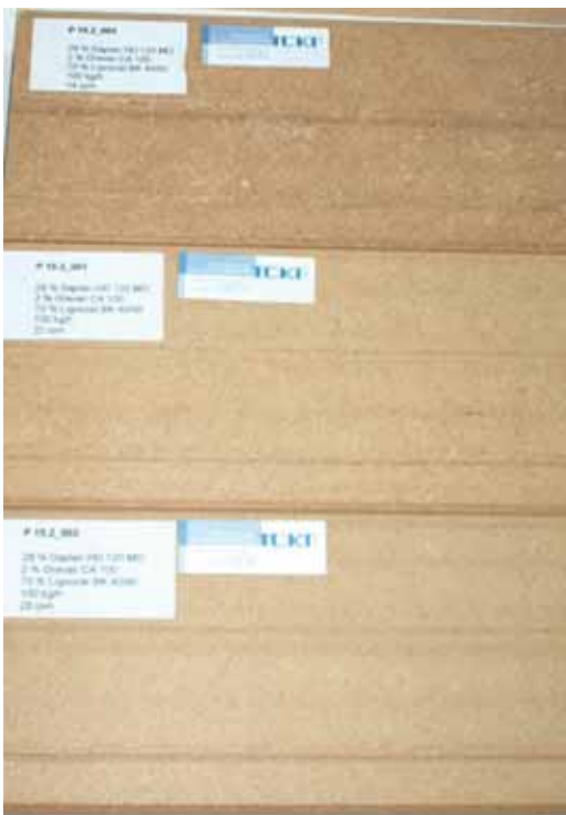
Abb 80: Einfluß der Schneckendrehzahl auf die Optik von extrudierten WPC-Profilen
