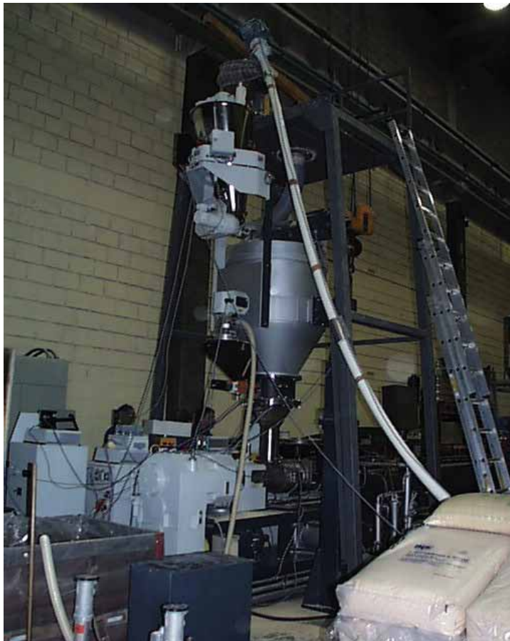
Abb 101: Adaptierte Zwangsdosierlösung aus der Kunststoffverarbeitung zur Verifizierung der Grundannahmen und Ermittlung der wichtigsten Konstruktionsdaten
