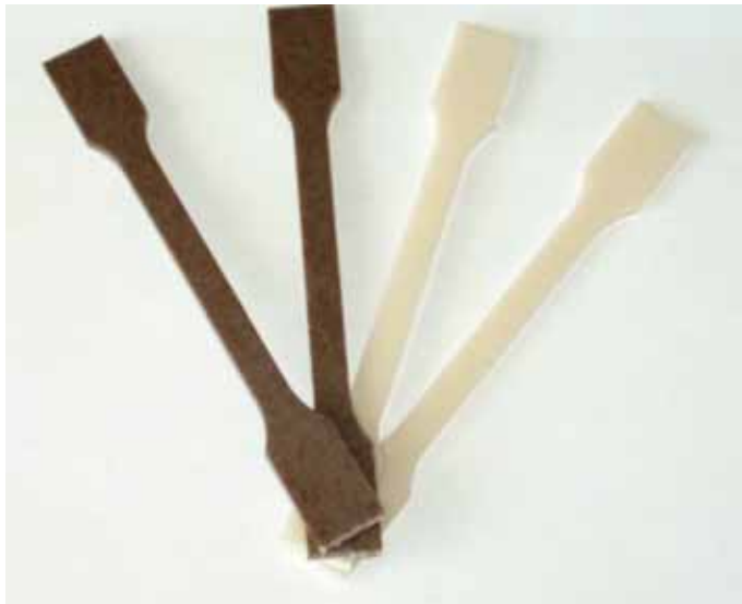
Abb 28: Universalprüfkörper gemäß ISO 294 (links reines Polymere, rechts WPC)
