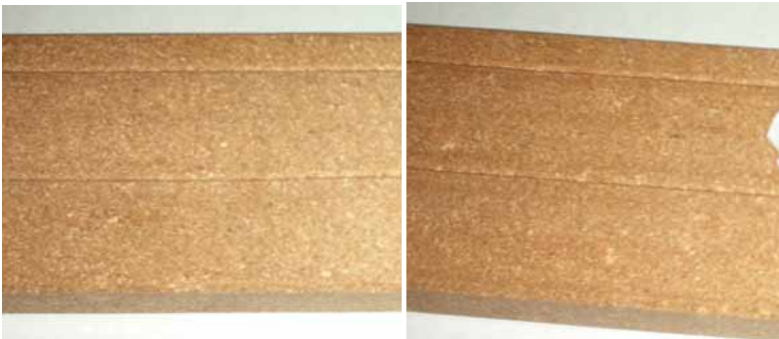
Abb 66: Einfluß der Form des eingesetzten Holzes auf die Optik von WPC-Profilen (links Holzspäne, rechts Pellets)
