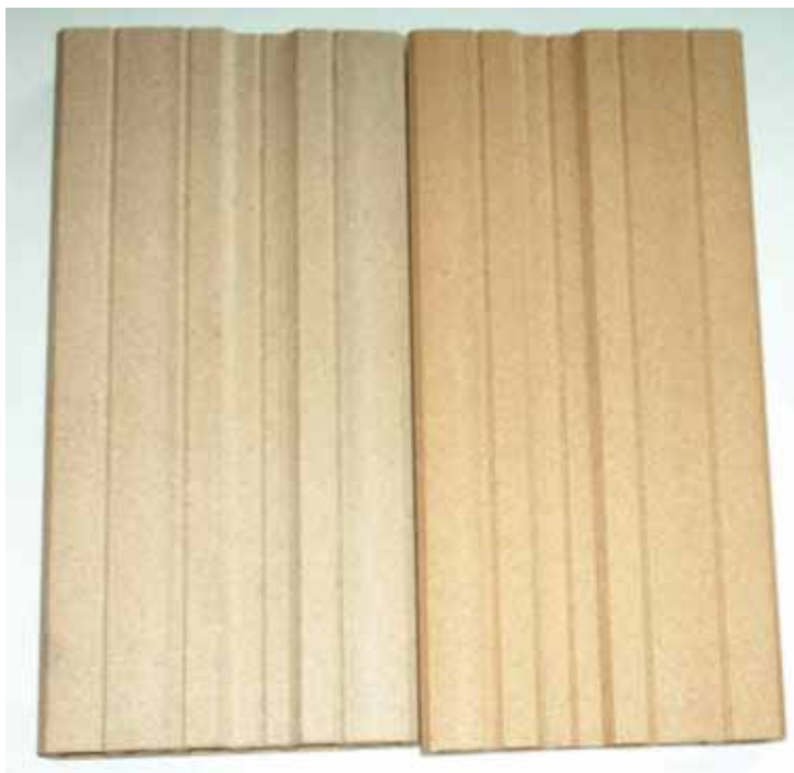
Abb 71: Vergleich von WPC-Profilen ohne und mit Haftvermittler
