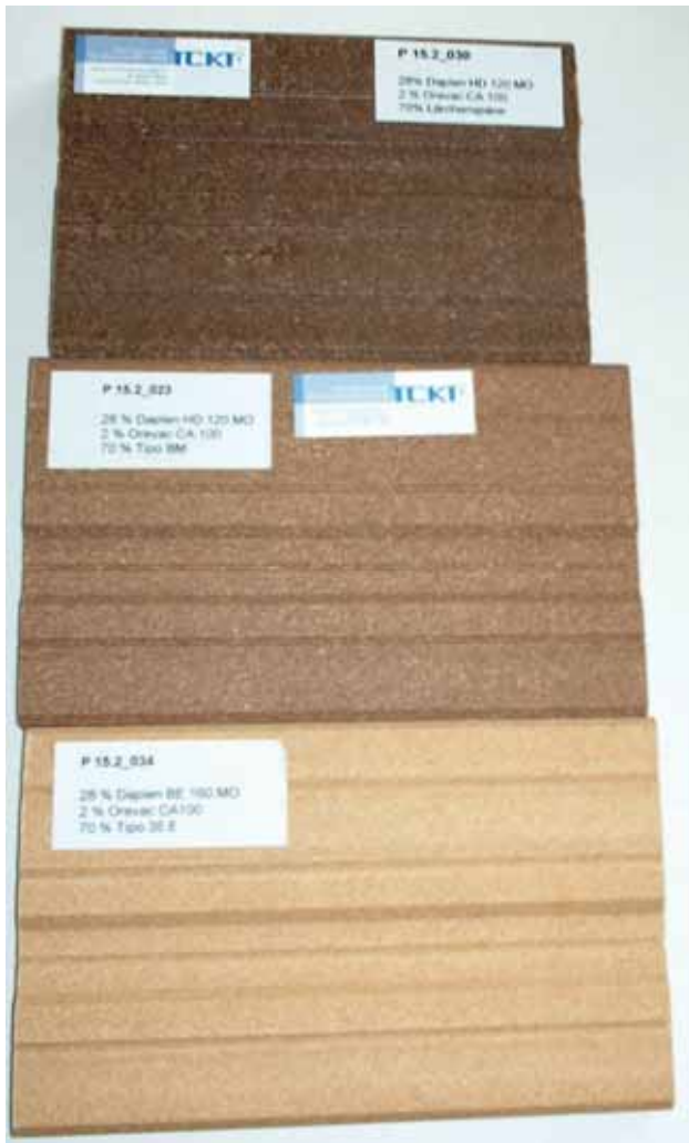
Abb 61: Einfluß der Holzart auf die Optik von WPC am Beispiel extrudierter Hohlkammerprofile (von oben nach unten: Lärche - Buche - Fichte)
