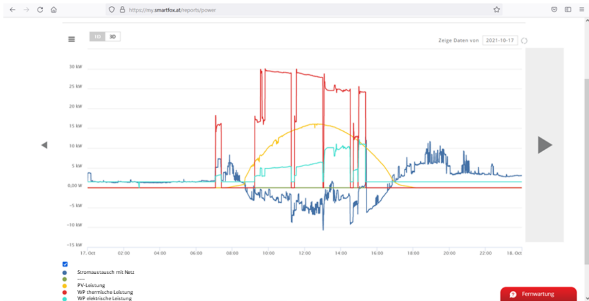
Abbildung 5-33: Leistungsverläufe des Smartfox-Energiemanager am 17.10.2021 mit Stromaustausch mit Stromnetz, PV-Erzeugerleistung, Wärmepumpe elektrische Aufnahmeleistung und Wärmepumpe erzeugte thermische Leistung.
