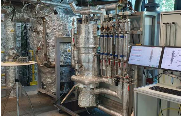
Versuchsanlage zur Wirbelschichtmethanierung, Foto: TU Wien
