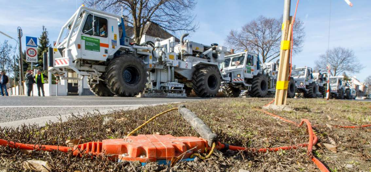
Impulsfahrzeuge bei 2D-Seismik-Messungen im Raum Wien und Groß-Enzersdorf, Foto: Wien Energie/Christian Hofer
