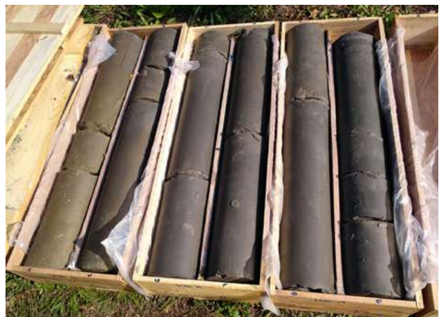
Die gesamte Bohrtiefe kann durch dunkelgraues, feinkörniges, toniges bis schluffiges Material charakterisiert und der Mergelfolge des Badener Tegel im Wiener Becken zugeordnet werden. Hier ein Teil der gewonnenen Bohrkern aus der 30 m-Kernbohrung, Foto: Projekt SANBA
