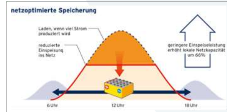
Netzoptimierte Betriebsführung von PV-Heimspeichersystemen (Bundesverband Solar e. V., 2013)
