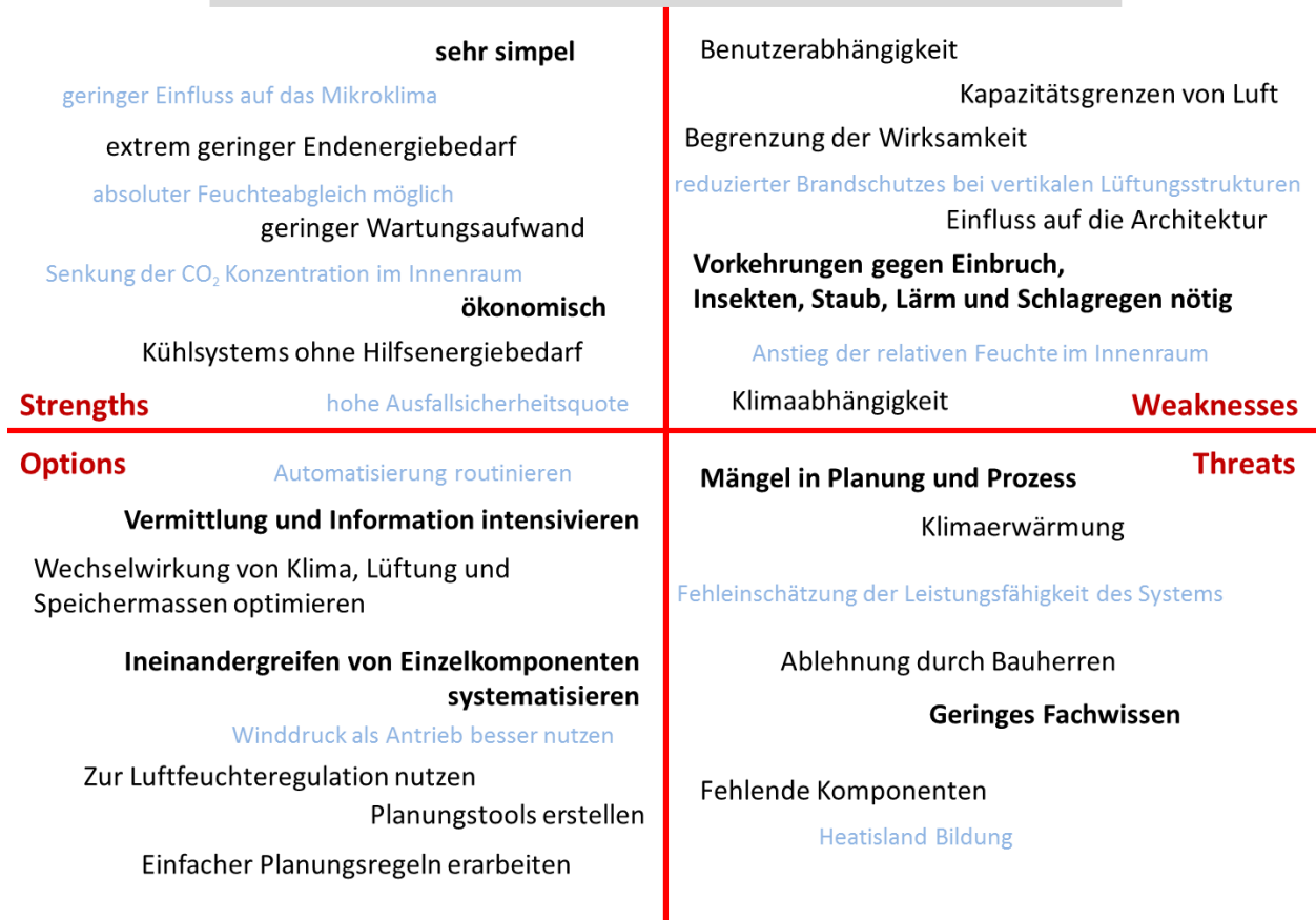
Abbildung 6: Übersichtsgrafik zur SWOT-Analyse: Ventilative Gebäudekühlung
