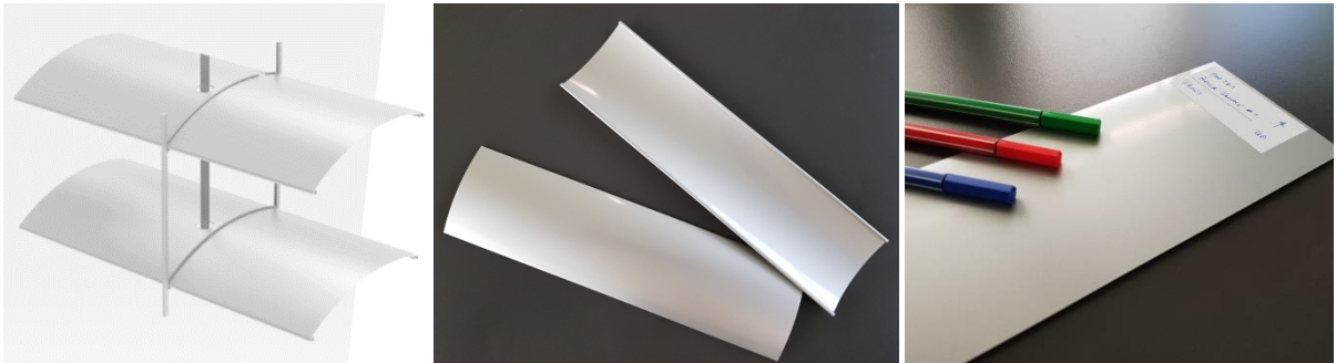
Abbildung 13: Muster der HELLA Außenjalousie ARB80 für den Rundversuch. Produktbild (links; Bild: HELLA), Testmuster der Lamellen (Mitte), Muster des Grundmaterials (rechts). (Bilder Mitte und rechts: Bartenbach)
