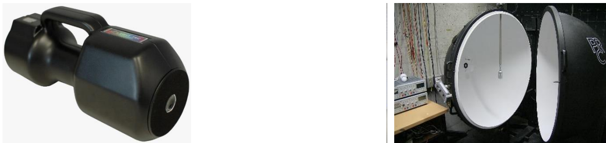
Abbildung 11: Messgeräte bei Bartenbach zur Charakterisierung von Tageslichtsystemen: BSDF Messgerät Mini-Diff (links), künstliche Sonne (Mitte), Ulbrichtkugel (rechts). (Bilder: Bartenbach)
