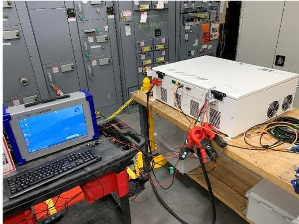
Abbildung 10: AIT Smart Grid Converter im Einsatz im Labor des U.S. amerikanischen Partners EPRI (Electric Power Research Institute, Knoxville, TN, USA), 2019, Quelle: AIT
