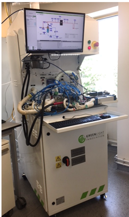
Abb. 6: G60 PEM Brennstoffzellen Teststand der Firma Greenlight und dessen Systemspezifikationen.
