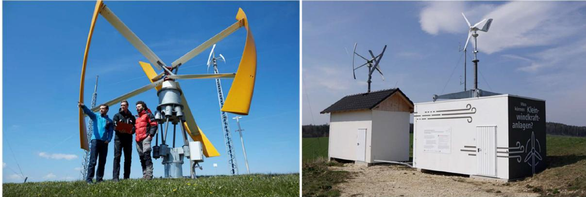
Abbildung 11: Kleinwindkraft zum Anfassen (links) sowie Messaufbau zur Evaluierung des Betriebsverhalten von gebäudemontierten KWEA (rechts) © FH Technikum Wien
