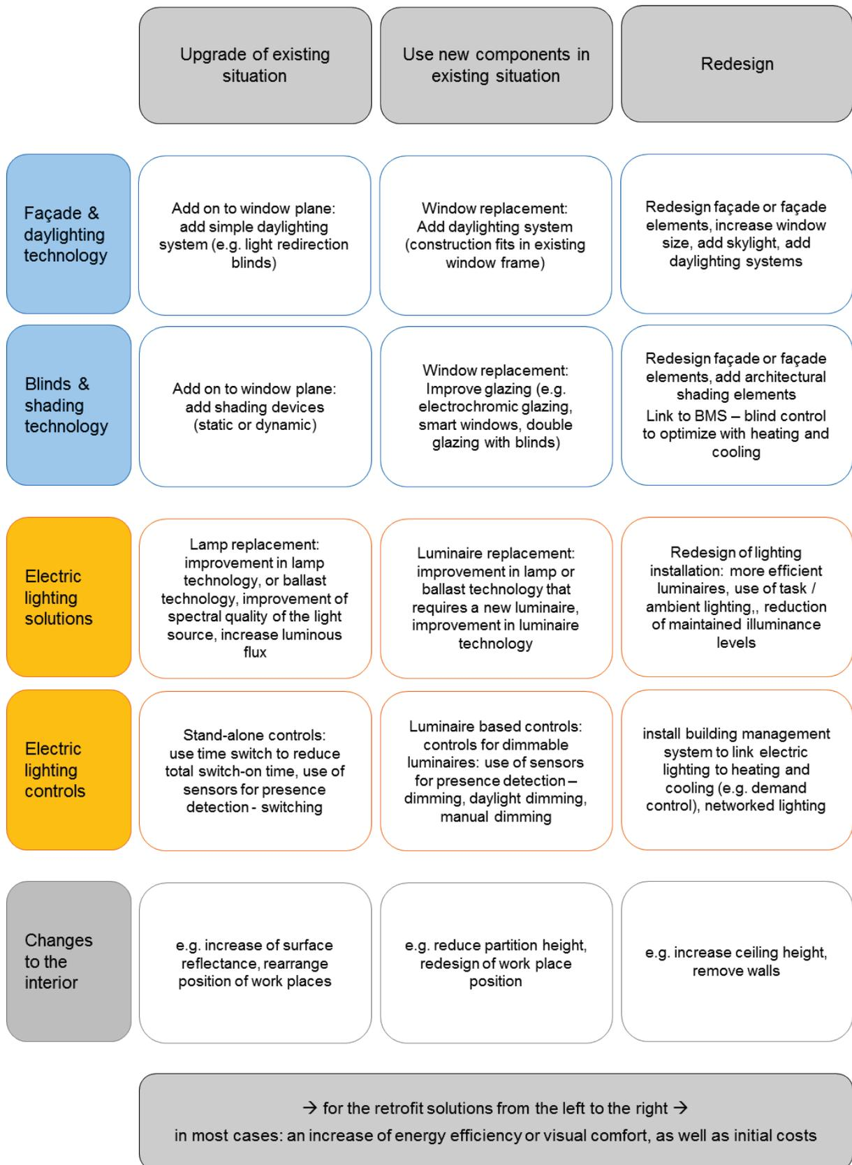
**Abbildung 1: Mögliche Ansätze zur Sanierung von Beleuchtungsanlagen**
