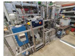
Brennstoffbereitstellung in hoher Reinheit (hier: Herstellung von 5.0 Wasserstoff mittels Chemical Looping Verfahren)
