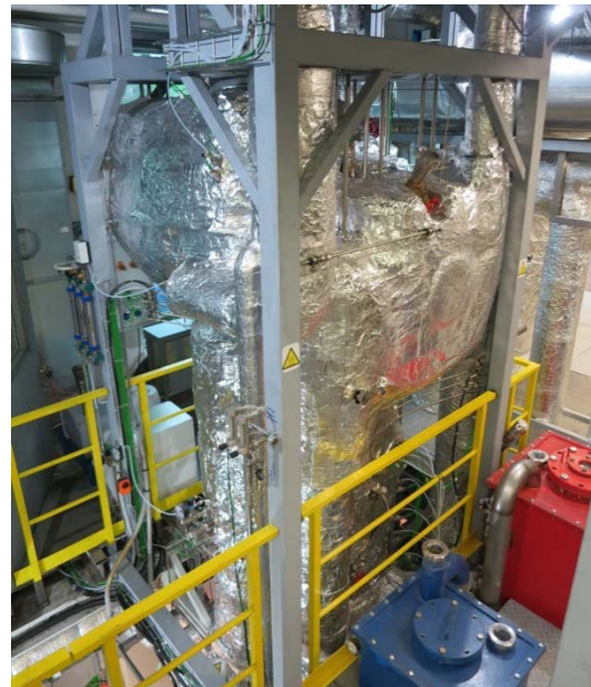
Abbildung 12 100 kW Pilotanlage der TU Wien mit der die Vergasung von Hühnermist durchgeführt wird
