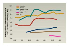
Geräteenergieverbrauch noch weiter reduziert. Länder, in denen sich Kühlschrankgrößen oder Gerätezahl je Haushalt schnell erhöhen, müssen wahrscheinlich mit einem zunehmenden nationalen Stromverbrauch im Bereich Kältetechnik rechnen.
