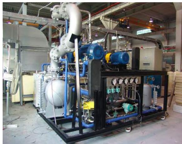
Abbildung 78: Prototyp einer Hybridwärmepumpe (IEA HPP Annex 35, 2014)
