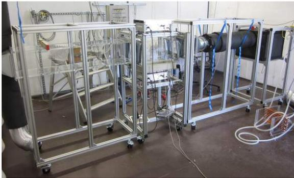
*Abbildung 69: Aufbau einer Versuchsanlage zur experimentellen Validierung der Kondensationsmodelle in den Klimakammern des AIT (Seichter et al., 2013)*
