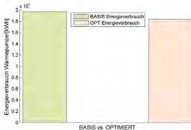
Abbildung 21: Darstellung des elektr. Energieverbrauchs der an der Regelung beteiligten Wärmepumpen für die konventionelle Regelung (BASIS) sowie die innovative, optimale Regelung (OPT).
