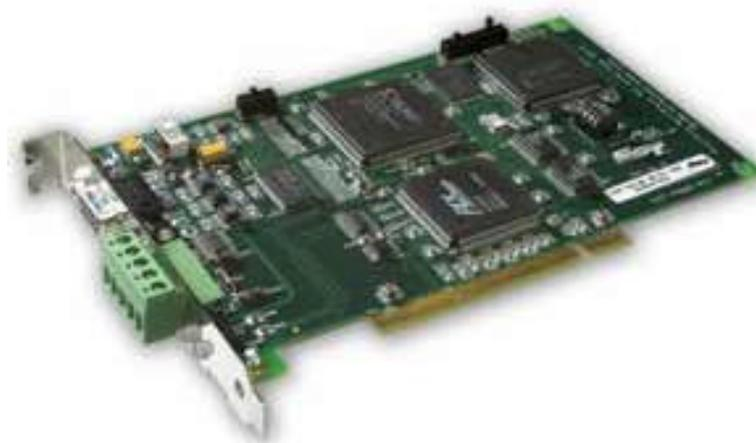
Bild 2: Profibus „DP Multi-Slave“ Interface Card (Quelle:
