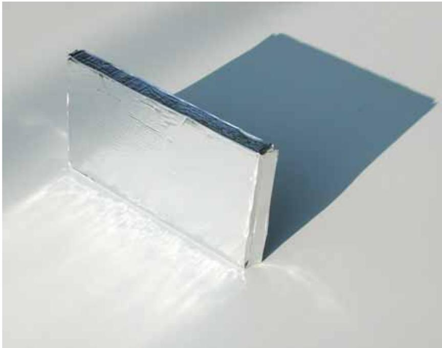
Abb. 3.21: Musterelement Vakuumdämmung mit Alu-beschichteter Hüllfolie
