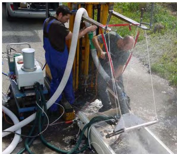
**Abbildung 12: Versuchsaufbau bei den Sprühversuchen mit Kleber und Wasserzudosierung.**
