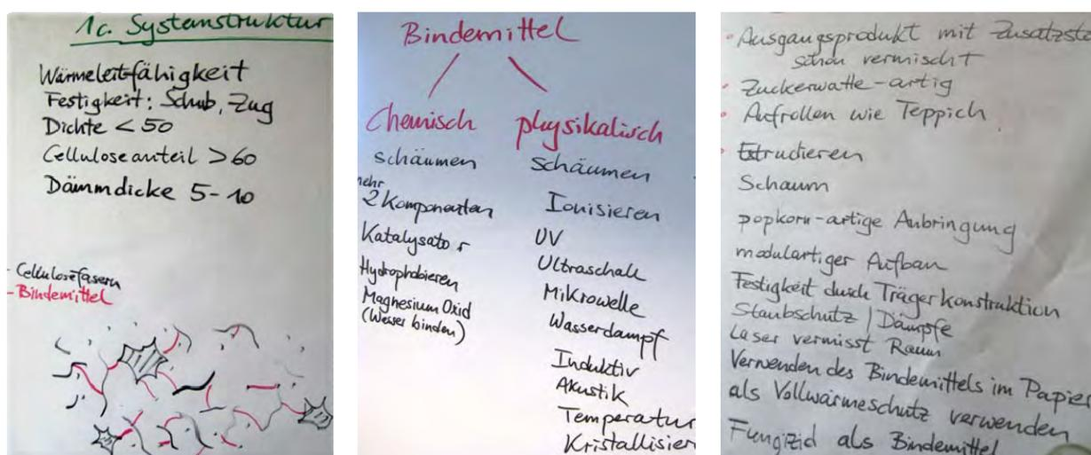
Abbildung 18: Flipcharts aus dem Kreativworkshop. Links: Skizze des Zellulose-Klebersystems. Mitte: Zusammenfassende Charakterisierung des Bindemittels. Rechts: Erste Ideensammlung
