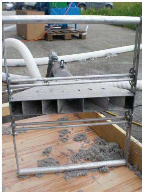
**Abbildung 10: Leitschaufeln in der Sprühdüse um den Zellulosestrom über die gesamte Breite gleichmäßig zu verteilen.**
