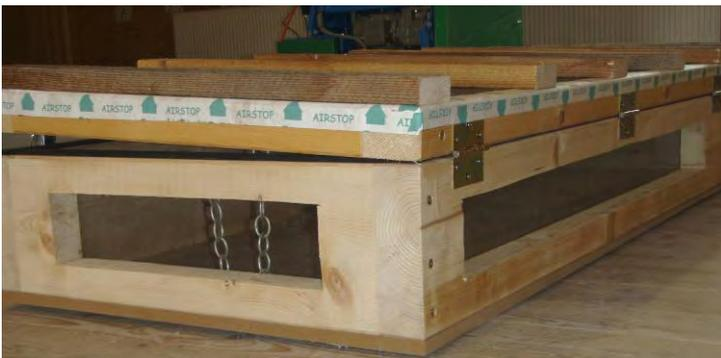
**Abbildung 15: Versuchskiste mit Sichtfenster zur Beobachtung des Füllprozesses.**
