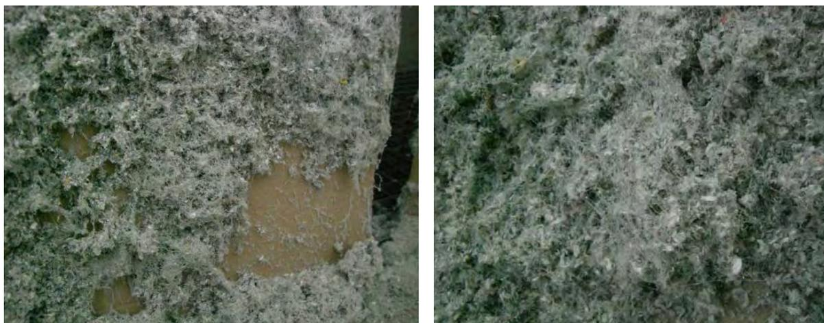
**Abbildung 6: Sprühbild des Zellulose-Kleber-Verbunds bei den ersten Versuchen.**
