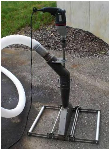
**Abbildung 9: Sprühdüse mit Propeller in der Zuführung zur gleichmäßigen Verteilung der Zellulosefaser vor der Kleberzudosierung.**
