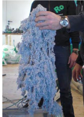
**Abbildung 17: Ergebnis der Versuche mit Zelluloseschleuder und Schmelzkleber.**
