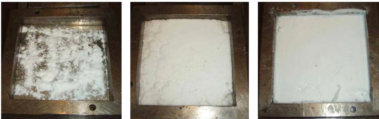
**Abbildung 20: Versuche mit reinem Expancel in der Heizpresse. Links: Ausgangszustand bei Raumtemperatur. Mitte: Material bis 80°C erwärmt. Rechts: Material bis 90°C erwärmt.**
