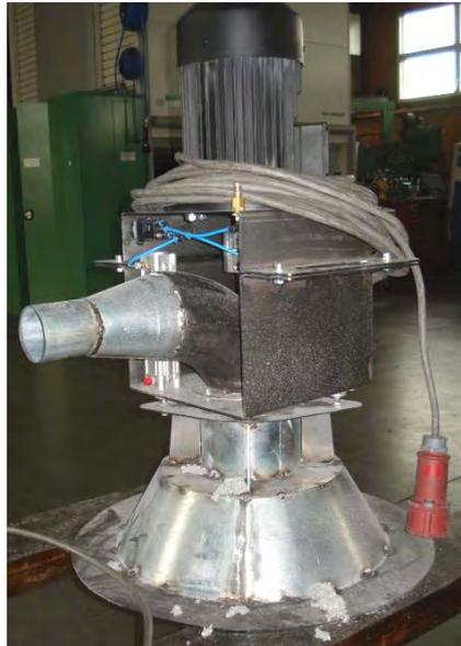
**Abbildung 14: Fertige Schleudereinheit zur besseren Verteilung der Zellulose in der Versuchskiste.**
