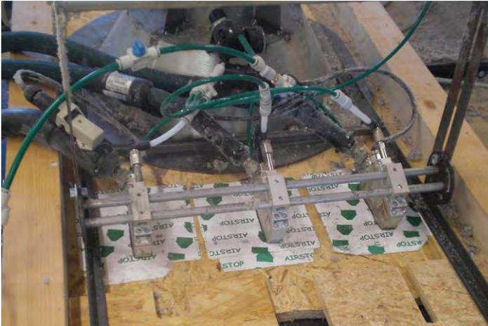
**Abbildung 16: Versuchsaufbau mit der Zelluloseschleuder und den Schmelzkleberdüsen.**
