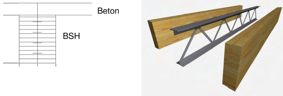
Abb. 46 Hybridkonstruktionen
