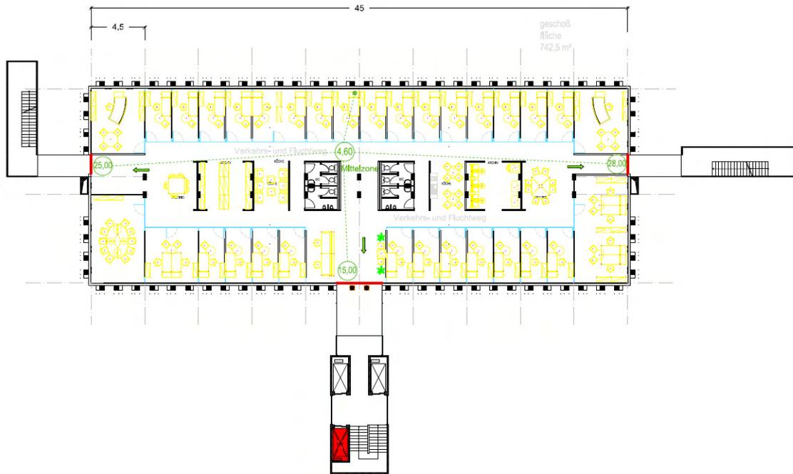
Abb. 27 Grundriss mit einem einzigen Mieter
