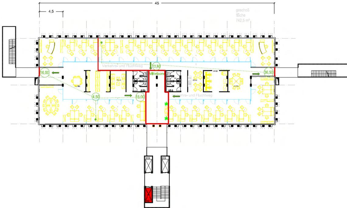
Abb. 29 Grundriss mit zwei Mietern auf unterschiedlicher Flächengröße
