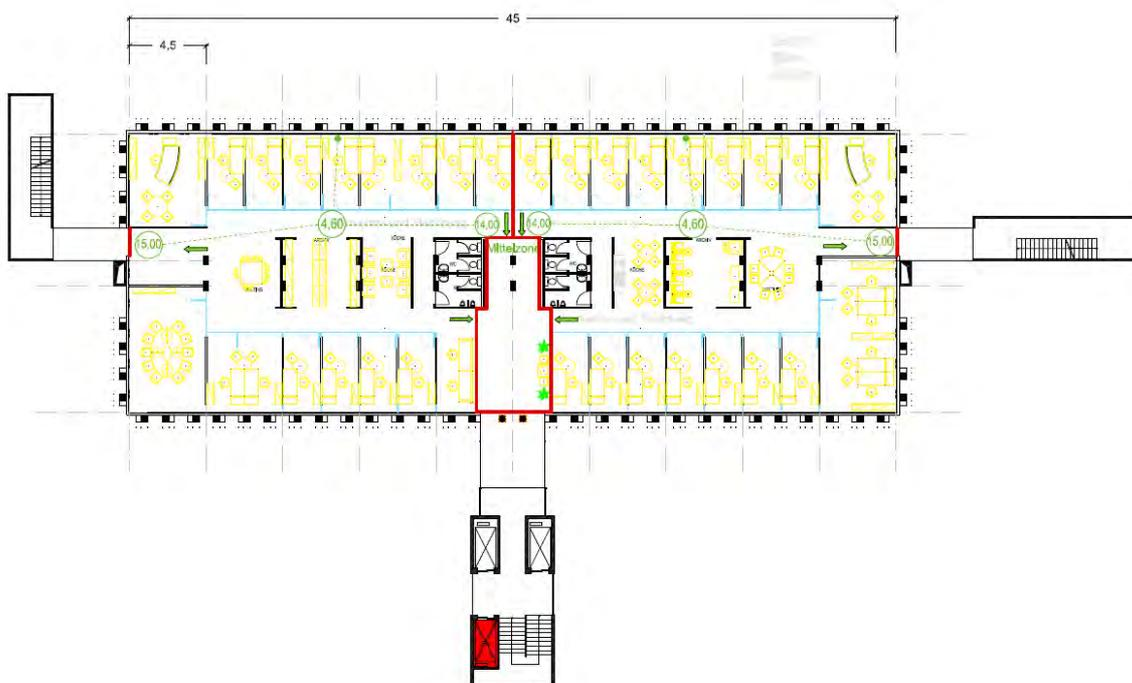
Abb. 28 Grundriss mit zwei Mietern auf gleich großen Fläche
