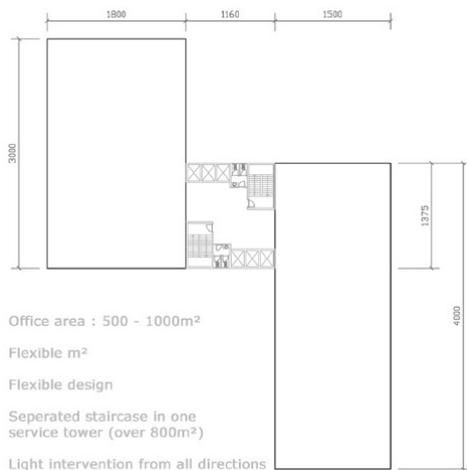
Abb. 15 Außen-Kern-Typus, Plan
