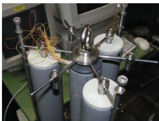
Behälter mit Phasenwechselmaterialien, die in einen Wasserspeicher eingebaut werden können, Quelle: IWT, Technische Universität Graz
