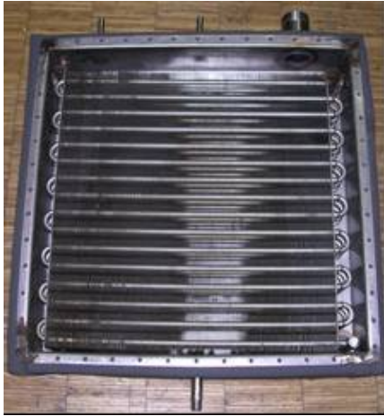
Bild 2: eingehängter Wärmetauscher in einen mit PCM gefüllten Tank. Links: Photo, rechts: Vergleich von Messung und Simulation für einen Entladeversuch.
