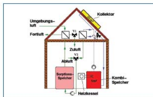
Einbindung eines Sorptionspeichers in die Lüftungsanlage (Arbeitsmedien Zeolith und Wasser), Quelle: IWT, Universität Stuttgart
