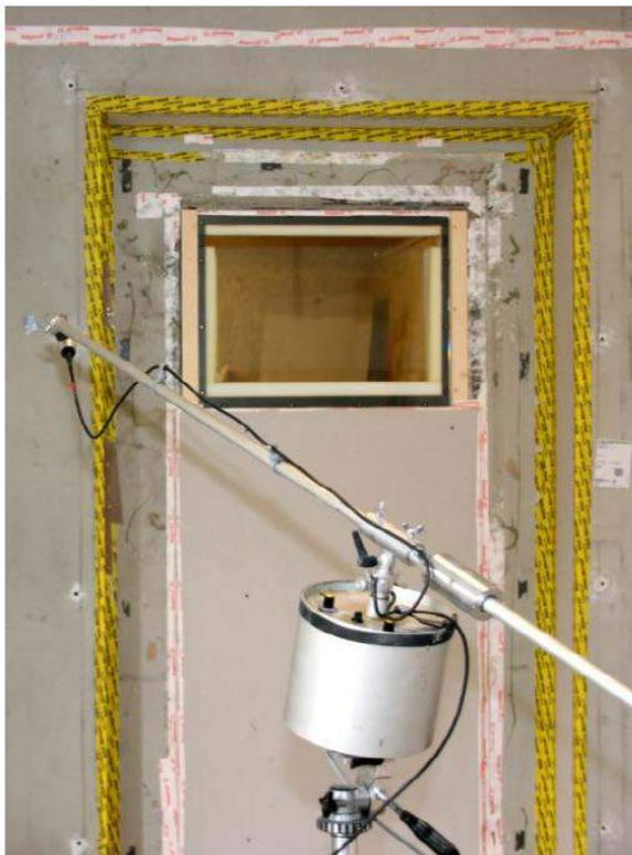
Abbildung 20: Prototyp Überströmer am Schallprüfstand (Quelle: PHI, Malzer)
