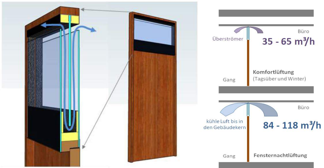
Abbildung 19: Prinzipskizze Überströmelemente (Quelle: PHI, Malzer)
