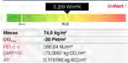
Abbildung 114: Bauphysikalisches Bauteilprofil von Variante 1 – Stopfhanf als Zwischensparrendämmung mit Lehmputzplatte (1,4cm) und Lehmfeinputz (mit Jutearmierungsgewebe)
