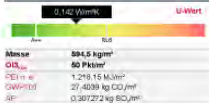
Abbildung 115: Bauteilprofil Variante 1 Strohballe, lasttragend / Holzfußboden – Sarleinsbach 2011
