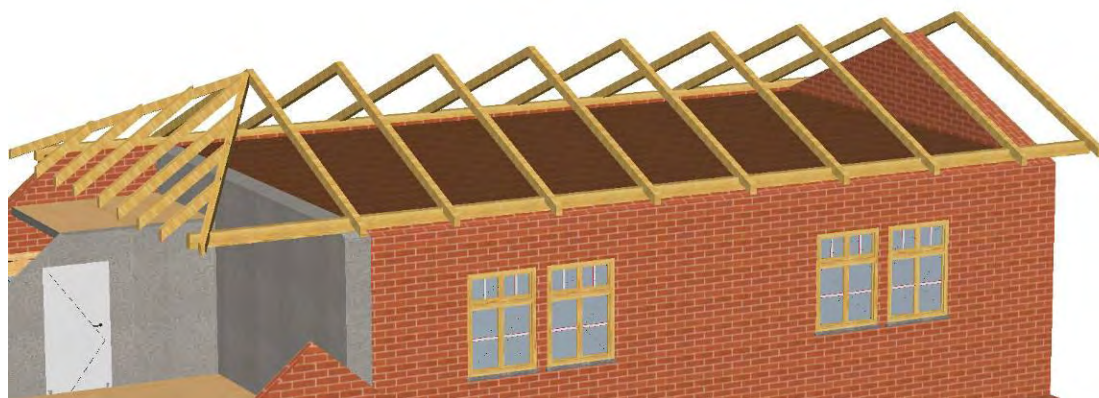
Abbildung 65: Darstellung der obersten Dachkonstruktion (ohne Mansarddachelemente)
