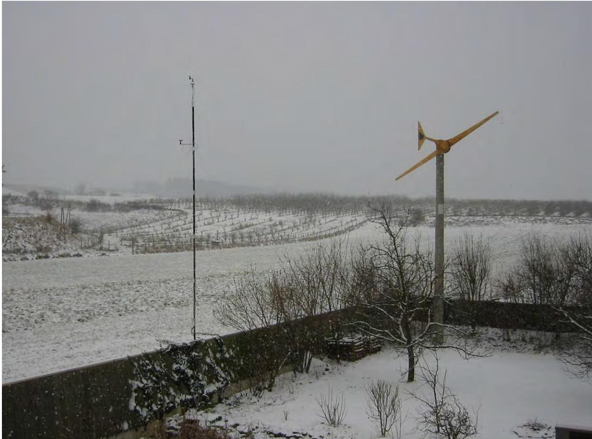
*Abb. 2: Grundsätzliche Situation der getesteten Kleinwindkraftkonzepte samt Windgeschwindigkeitsmeßsystem mit mehreren Schalenkreuz-Anemometern auf eigenem Mast*
