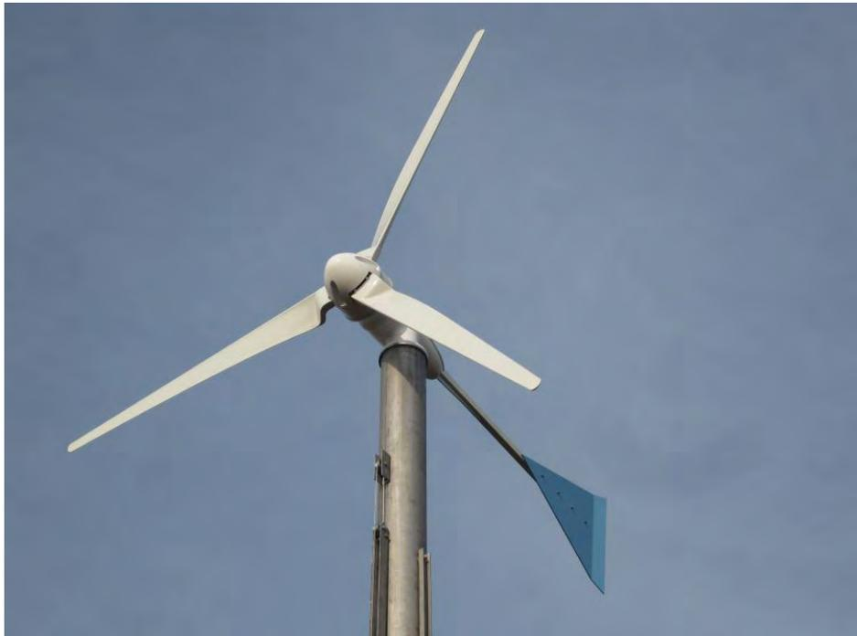
*Abb.5: Dreiblatt-Propellerrotor (4,5m Rotordurchmesser) mit elektronischer Drehzahlbegrenzung*
