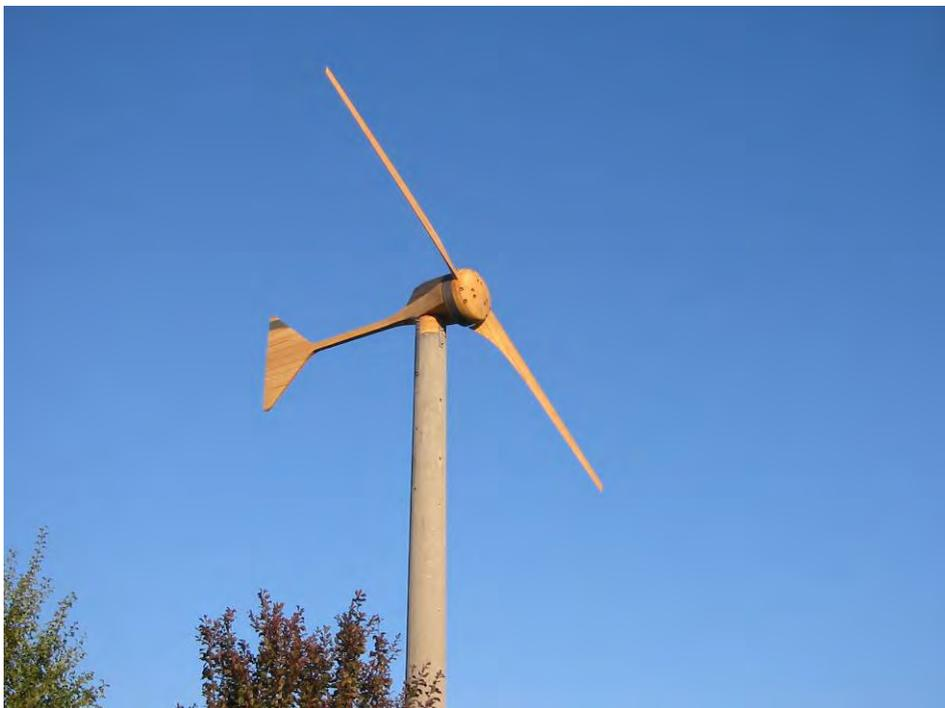
*Abb.4: Zweiblatt-Propellerrotor ( $16\text{m}^2$ ) mit elektronischer Drehzahlbegrenzung – Selbstanlauf bei  $1,3\text{m/s}$*
