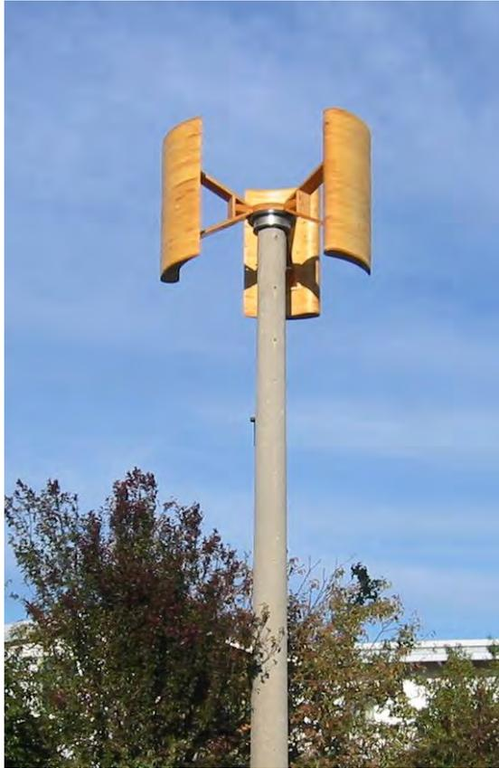
*Abb. 3: H-Rotor ( $3,5\text{m}^2$ ) mit Flügelblattprofil mit großer Flügeltiefe - Selbstanlauf bei  $1,9\text{m/s}$*
