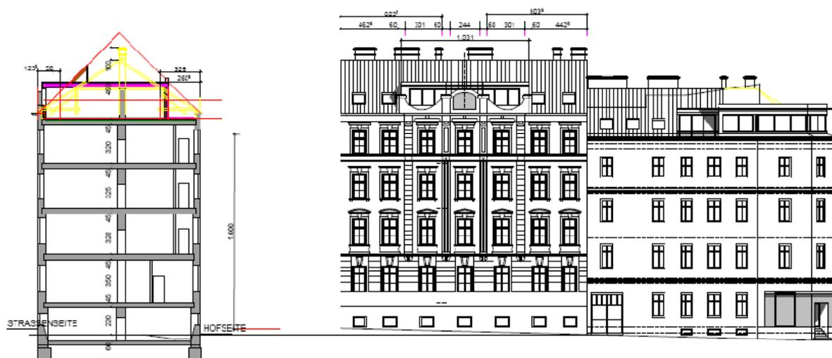
**Abbildung 5: Straßenansicht Muhrengasse nach der Sanierung**
