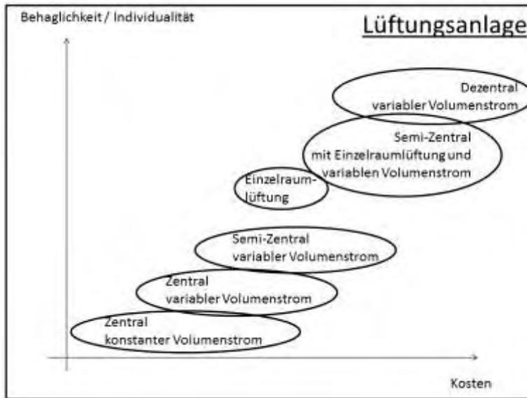
**Abbildung 137: Gegenüberstellung der Kosten im Verhältnis zu Behaglichkeit / Individualität bei verschiedenen Lüftungsanlagen**
