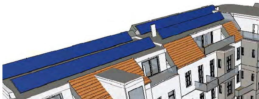
**Abbildung 39: Solarthermische Anlage am Objekt David's Corner**
