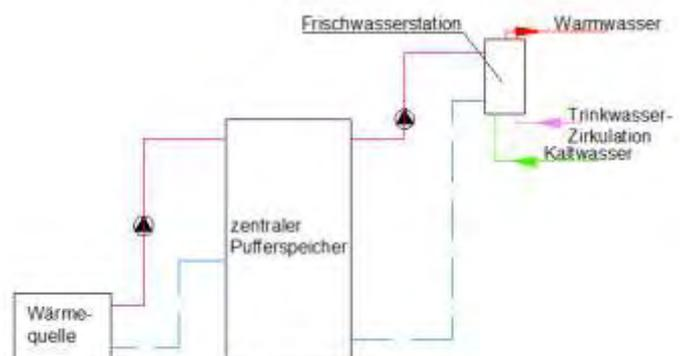
**Abbildung 136: Prinzipschema dezentrale Warmwasserbereitung**
