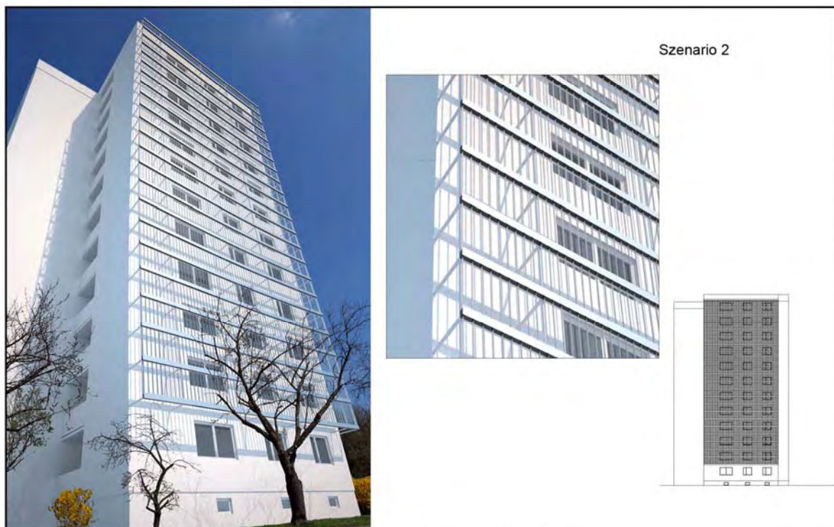
Perspektive, Detailausschnitt und Ansicht M 1:500 Szenario 2 mit Vakuumröhren-Screen
