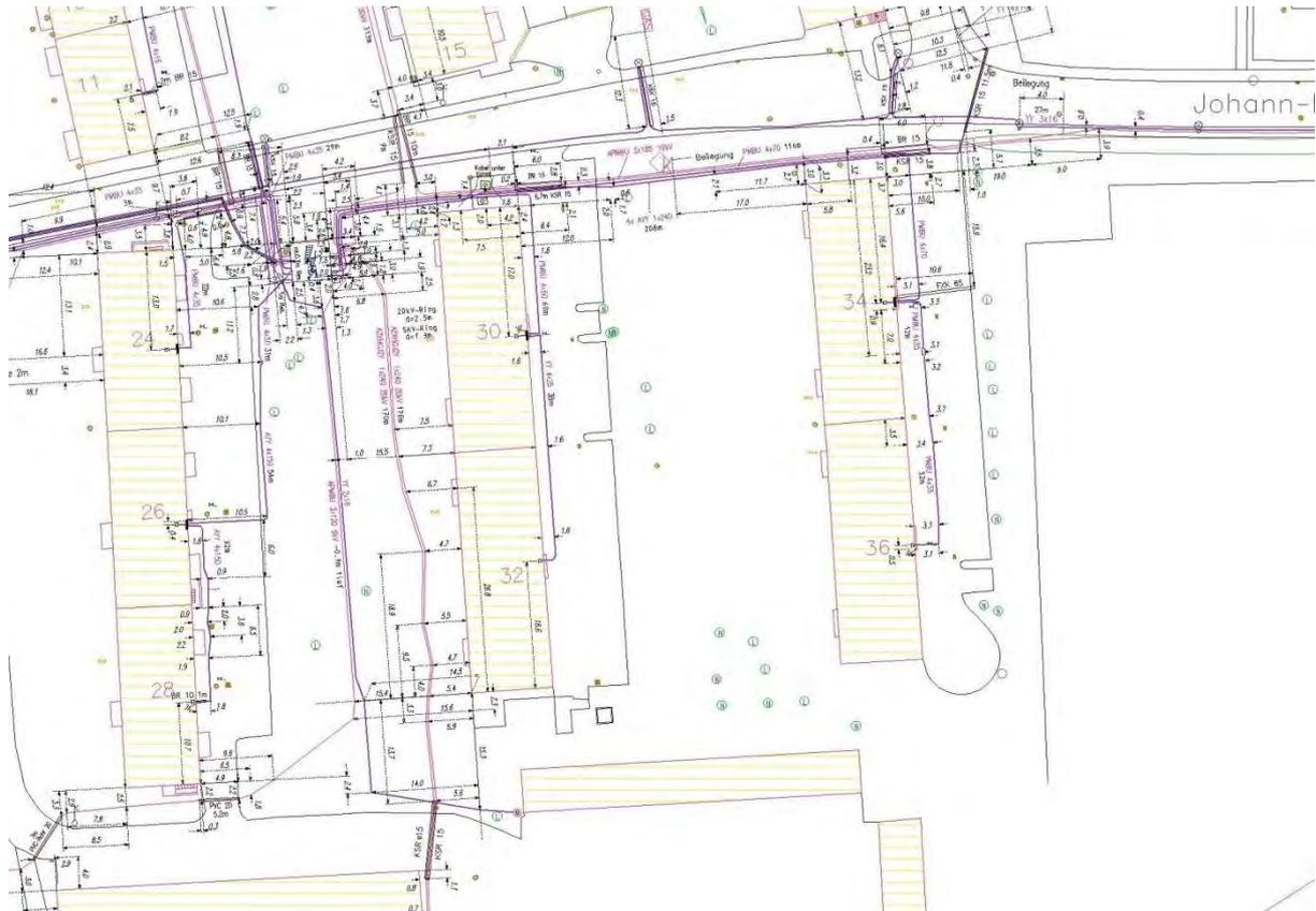
**Abbildung 13: Stromleitungsführung in der Umgebung des Demonstrationsprojektes „Johann-Böhmstraße, Kapfenberg“ (Quelle: Stadtwerke Kapfenberg GmbH)**
