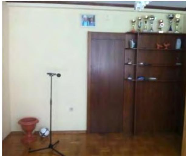
Abbildung 8: Links: Senderraum mit „Trittschallhammerwerk“; rechts: Empfangsraum mit Empfangsmikrofon (Quelle: Vatter & Partner ZT-GmbH)
