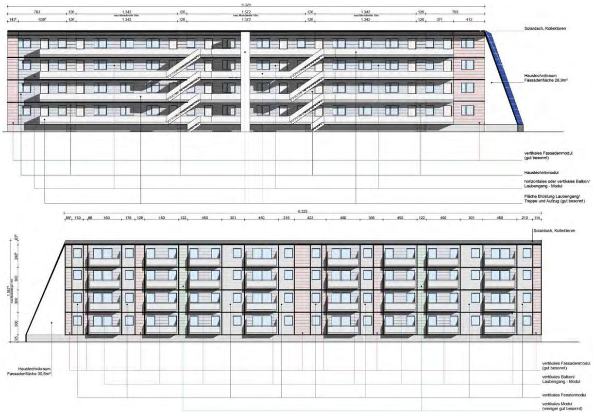
**Abbildung 23: Designstudie 3 mit Analyse der Fassadenflächen hinsichtlich der Möglichkeit solarer Energieproduktion – „Johann-Böhmstraße, Kapfenberg“ (Quelle: Nussmüller Architekten ZT GmbH)**
