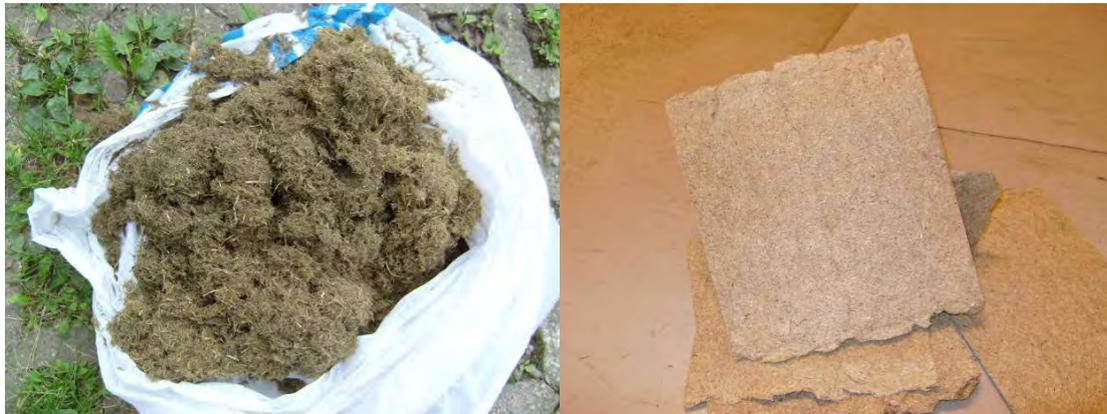
Abbildung 8-4: Aufbereitete Grasfasern (links) und Grasfaser Vlies (rechts) für die Substratversuche
