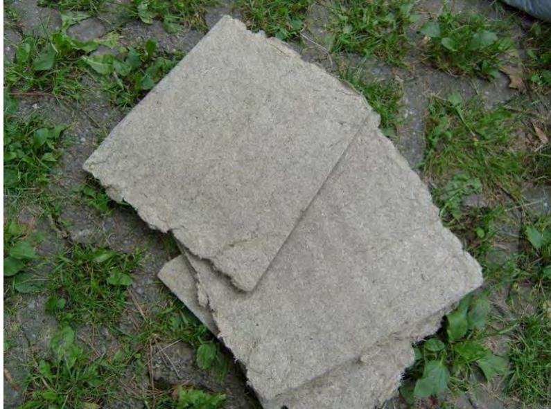
Abbildung 8-19: Gepresstes Vlies aus aufbereiteter Grasfaser
