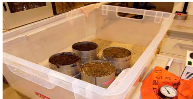
*Abbildung 8-5: Versuchsanordnung zur Bestimmung der Saugspannung – Sand-Saugspannungstisch*
