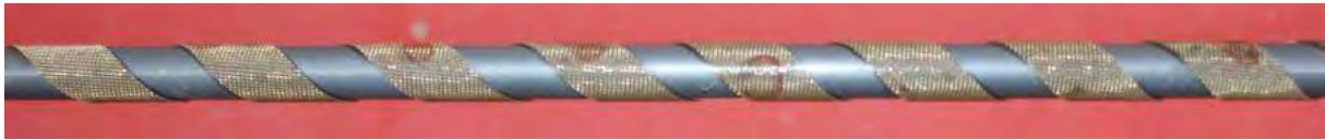
Abb. 127: Demontierter Receiver mit Korrosionsflecken (Außenansicht des inneren Rohres)
