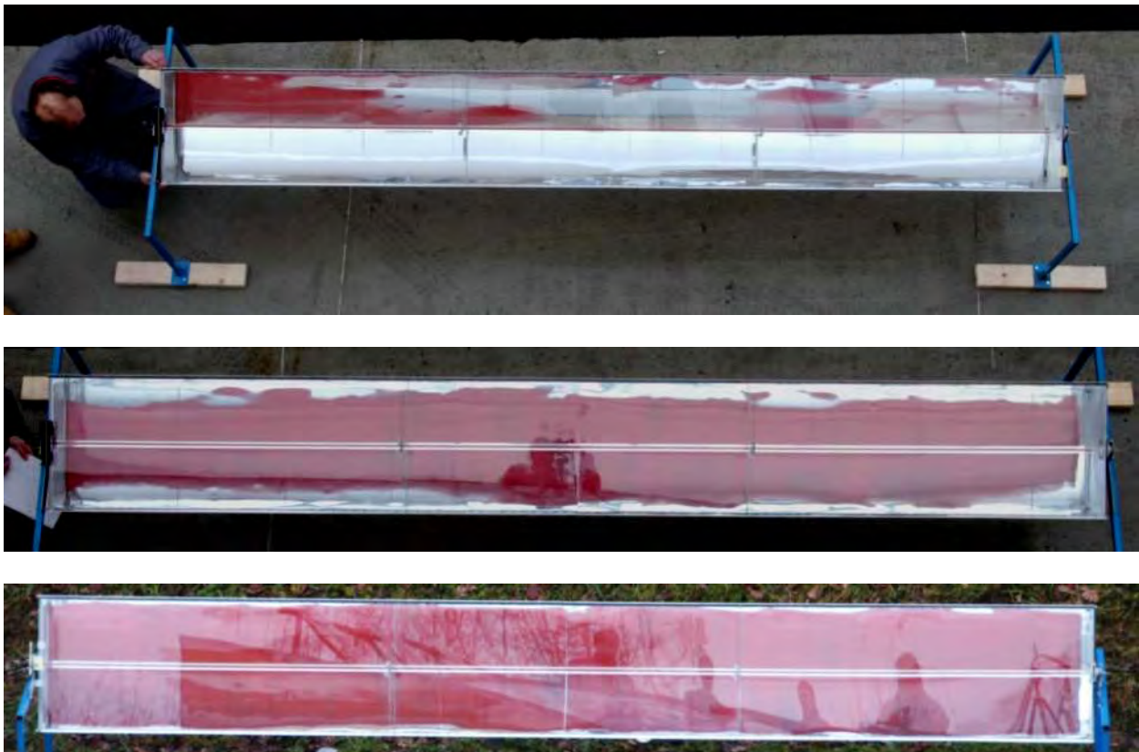
Abb. 48: Ansichten des Kollektors mit rot gefärbtem Absorberrohr. Aus der Ausdehnung der roten Flächen lassen sich Rückschlüsse über die Konzentradorqualität ziehen. Oben: aus 7,7 m Entfernung, Mitte: Messbild in optischer Achse aus 7,7 m Entfernung, unten: in optischer Achse aus 35 m Entfernung
