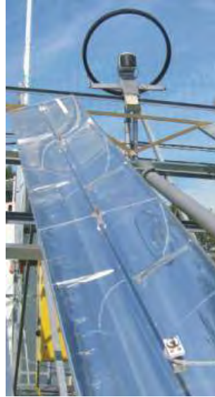
Abb. 2: Parabolrinnenkollektor der Firma Button Energy am Teststand der AEE INTEC (Bildquelle: AEE INTEC)
