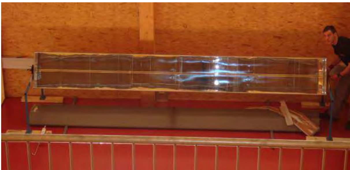
Abb. 111: Einstellen der Receiverposition. Überall dort, wo der Reflektor schwarz erscheint, spiegelt sich das schwarze Receiverrohr. Dieses ist damit im Fokus.
