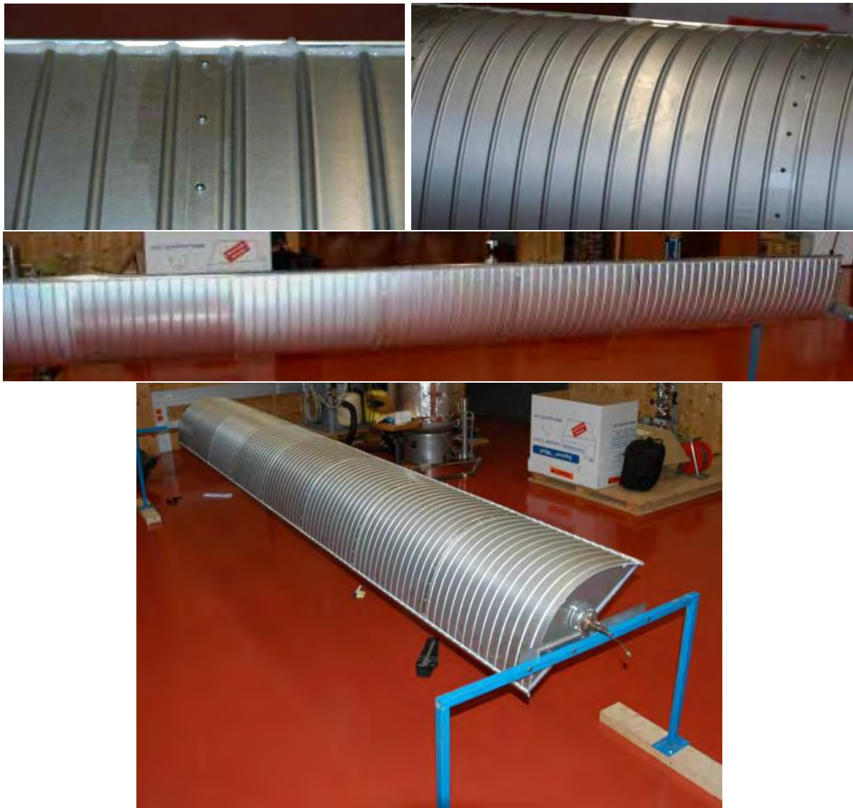
Abb. 47: Rückseite des Kollektors aus profiliertem Aluminiumblech mit Silikonabdichtung Die Kollektorkonstruktion weist durch die Bauweise eine sehr gute Stabilität auf. Es konnte keine Torsion des Kollektors in sich festgestellt werden. Auch aufgebrachte Kräfte beeinflussen die Geometrie nicht nennenswert.
