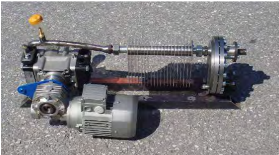
Abb. 100: Kolbenmembranpumpe, die im Primärkollektorkreis eingesetzt wird
