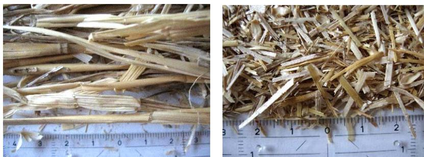
Abbildung 2: Stroh unbehandelt und konditioniert (rechts)
