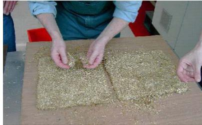
Abbildung 30: keine ausreichende Verbindung der Fasern in der Mittelebene
