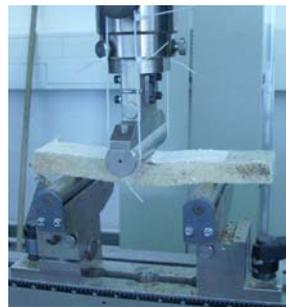
Abbildung 67: Wand-Außenschicht auf Druck belastet
