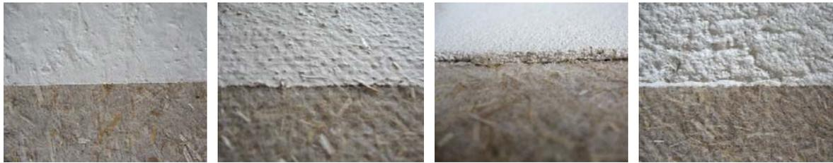
Abbildung 42: Verbindung Putz – Vlies
