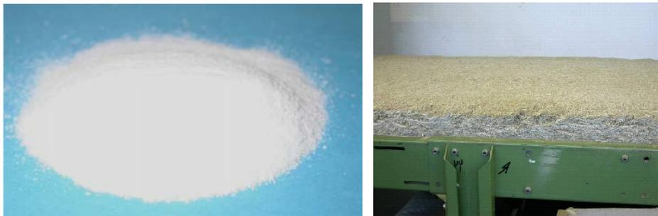
Abbildung 21: Vlies nach dem Vlieslegeprozess mit chem. mod. Stärke; erkennbar am weißen Querschnitt
