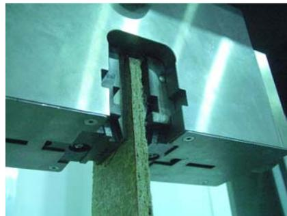
Abbildung 25: Probe bei der Überprüfung auf Zugfestigkeit
