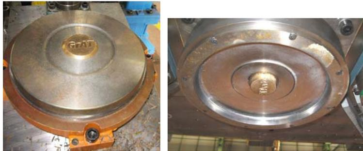
Abbildung 60: Frisbee, zweiteilige Pressform
