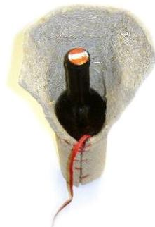
Abbildung 64: Flaschenverpackung aus unverpresstem Naturfaservlies
