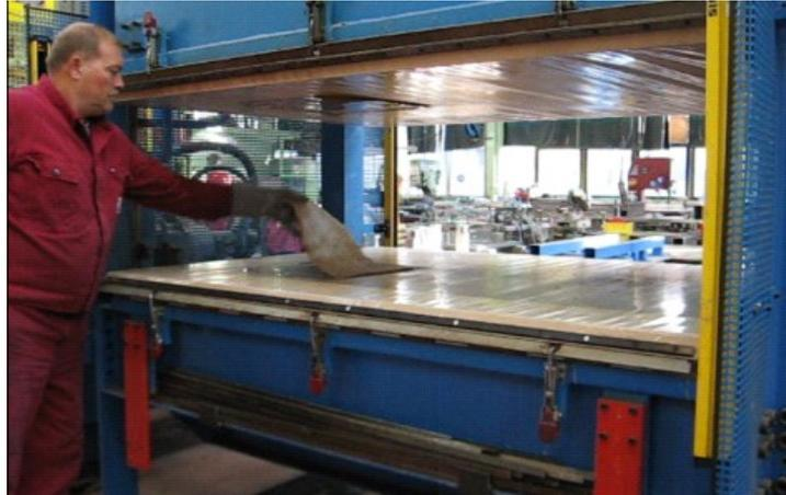
Abbildung 61: Entnahme aus der Heizpresse
