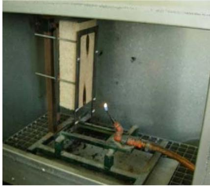
Abbildung 65: Beflammter Prüfkörper
