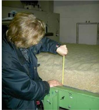
Abbildung 13: Vlies vor dem Thermobonding
