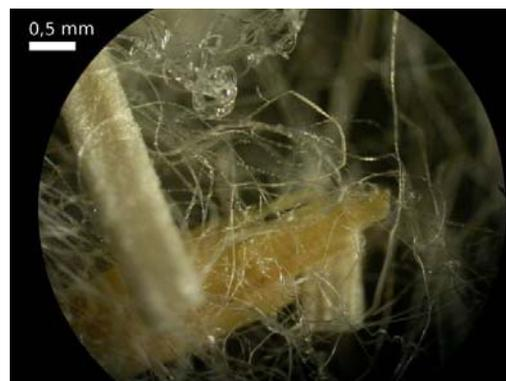
Abbildung 16: Stroh, Leinenkämmlinge, PLA; Vlies nach dem Thermobonding
