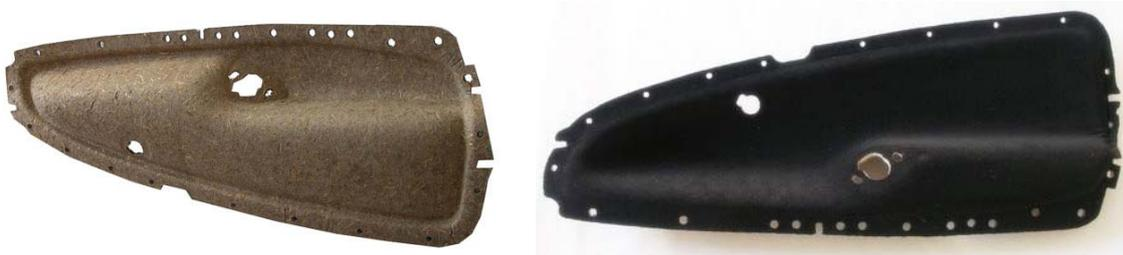
Abbildung 50: Auto – Innenverkleidung, Innenseite unbehandelt, Außenseite mit „Soft Touch“
