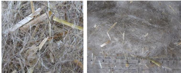
Abbildung 4: Strohspäne und Flachsfasern, Faserflor
