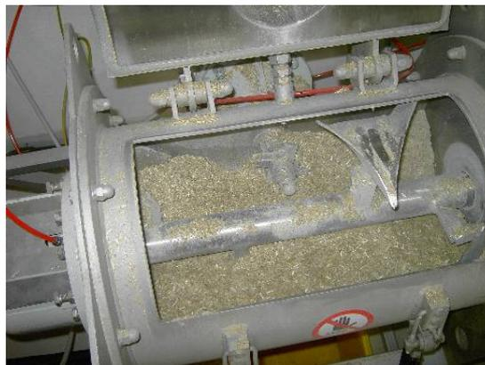
Abbildung 27: Einwellen-Wurfschaufelmischer
