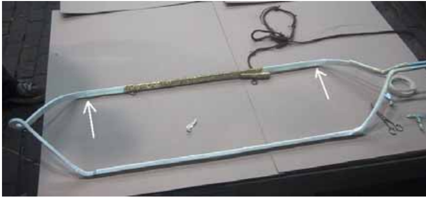
Abbildung 34: Die Pfeile bezeichnen bei der Niederspannungsformspule die Lage der Isolation der Nutauskleidung
