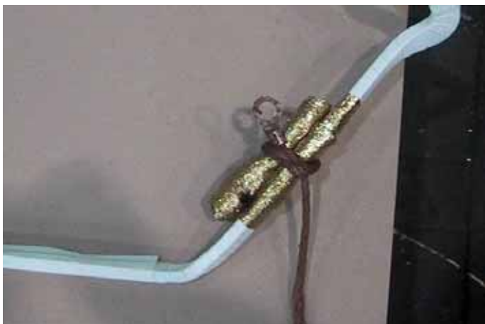
Abbildung 36: typischer Versuchsaufbau zur Ermittlung der Durchschlagsspannung bzw. Teilentladung
