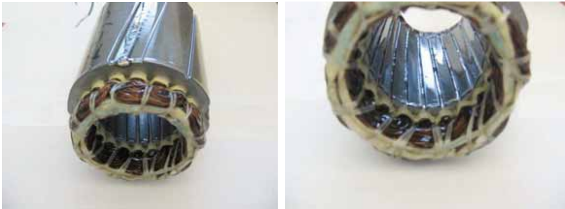
Abbildung 30: Wickelkopf des Silikonharz – getränkten Motors
