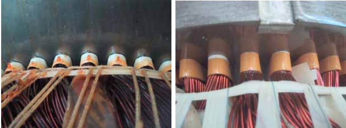
Abbildung 54: Tropfenbildung am Nutausgang
