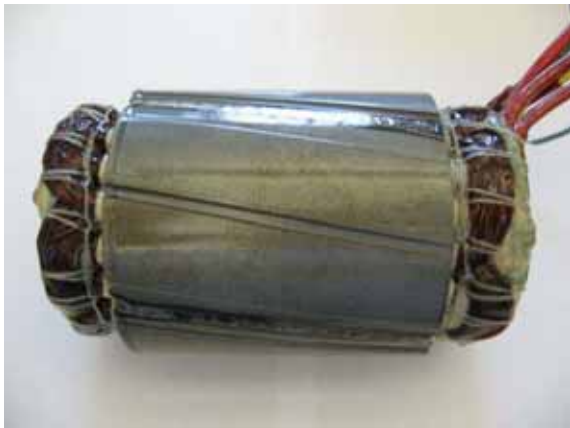
Abbildung 28: Mittels Silikonharz getränkter Versuchsstator
