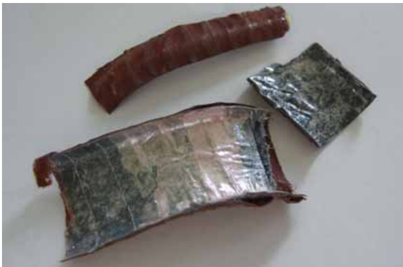
Abbildung 49: Nach dem Härten abgelöstes Isoseal Deckband
