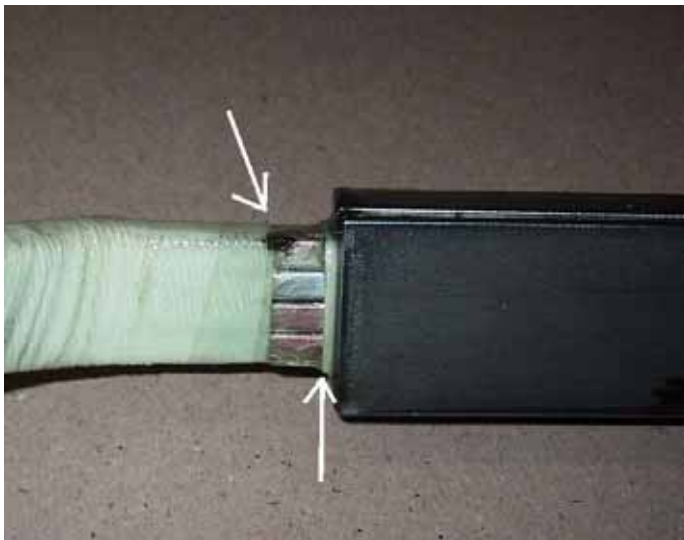
Abbildung 35: Der angeschwärzte Punkt des Durchschlages ist gut zu erkennen. Die Nutauskleidung ist zwar ein wenig zu kurz dimensioniert, die Spannung des Durchschlages liegt aber trotzdem noch über der Prüfspannung
