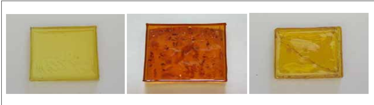
Abbildung 11: Ein in dicker Schicht ausgehärtetes Polymer welches ein ungünstigen Schrumpfungsverhalten zeigt kann zu Spannungsbrüchen neigen (links: optimal ausgehärtetes Harz, mitte: mehrere Makrorisse über das ausgehärtete Material verteilt, rechts: ein großer Spannungsbruch)
