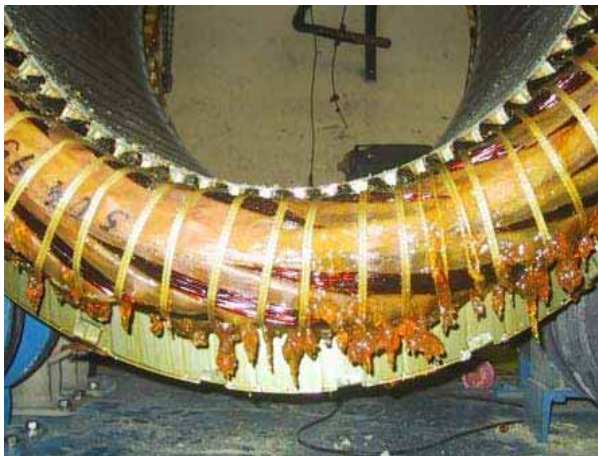
Abbildung 53: Tropfenbildung am Wickelkopf nach dem Härteprozess
