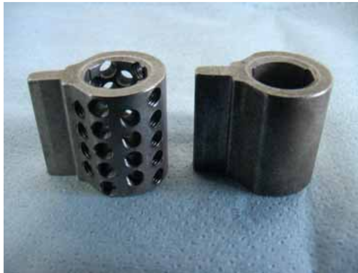
Abb. 18: Werkstücke aus Sintermetall nach (links) und vor (rechts) dem Gewindeformen
