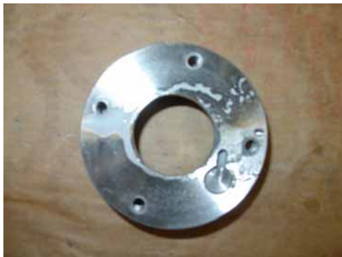
Abb. 32: Verunreinigung der Zahnkränze
