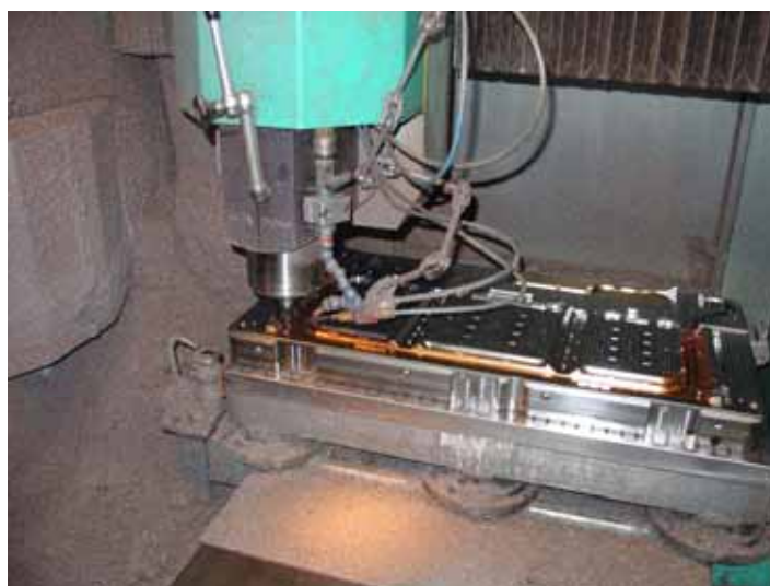
Abb. 25: Im Einsatz befindliche Injektordüse
