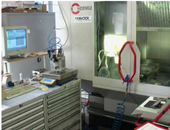
Abb. 6: Die Hermle 5-Achs-Bearbeitungsmaschine im Zerspanungslabor von Profactor
