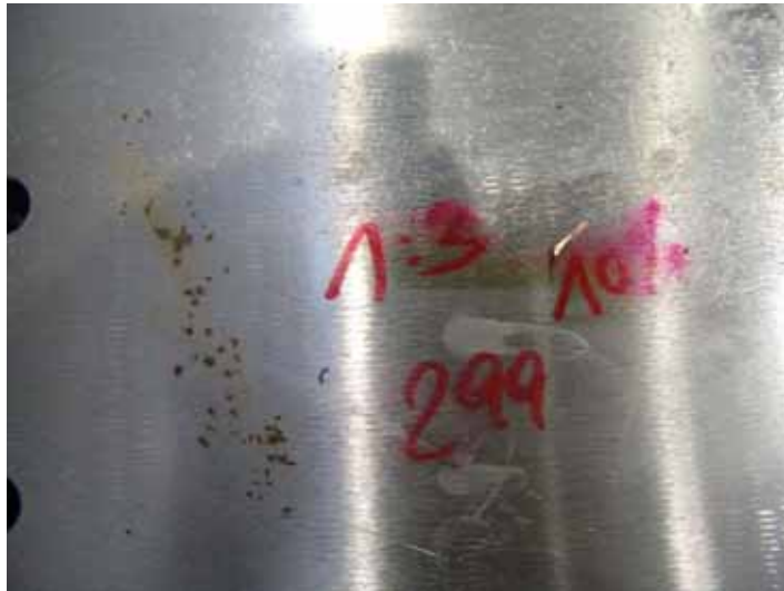
Abb. 28: Verringerte Oxidation durch Zusatz von Antioxidationsmittel
