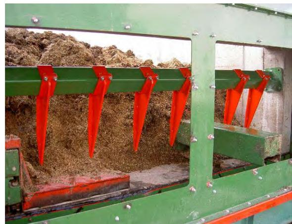
Abbildung 28: Erste Praxistests mit Gras u. Maissilage. Probleme mit Brückenbildung bei Querschnelle, Einbau von Gegenhalter bei Förderschnecke, - dadurch erhöhter Kraftbedarf und Bruch der Schubelemente
