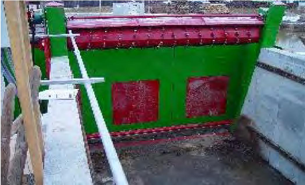
Abbildung 9: Hydraulisch angetriebene Frästrommel und Querförderschnecke für die Verarbeitung aller anfallenden Substrate
