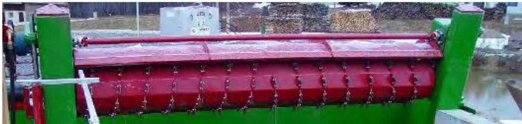
Abbildung 12: Einbringung von Komponenten im losen und gepressten Zustand; Auflösung der Strukturen durch Frästrommel
