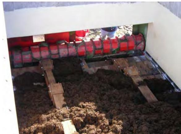
Abbildung 37: Steuerung des Schubbodens mit hydraulischer Dosierwalze. Über die Lastaufnahme der Drehmomentstütze wird die Funktion des Schubbodens gesteuert.
