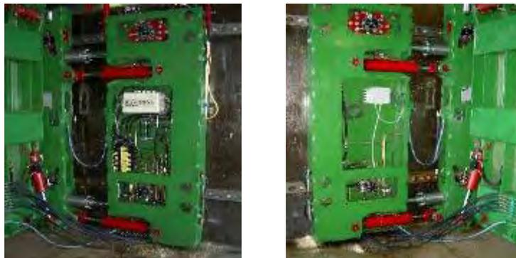
Abbildung 19: rechter und linker Abschiebschlitten mit Ausschub- und Absteckzylinder,
