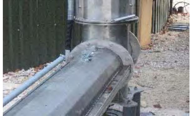
Abbildung 41: Querförderschnecke und Steigschnecke mit Übergabestation
