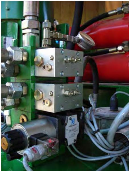
Abbildung 38: Umbau des Schubbodens mit Druckumschaltventile und Einbindung in die SPS
