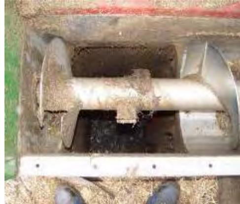
Abbildung 15: Übergang von der Querförderschnecke zum Fallschacht
