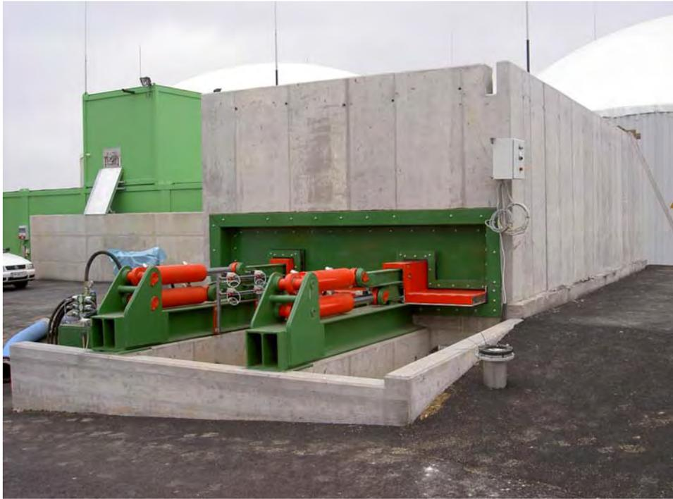
Abbildung 13: Betonierter Schubbodenbehälter mit gegenläufigen Hydraulikzylindern und Aggregat
