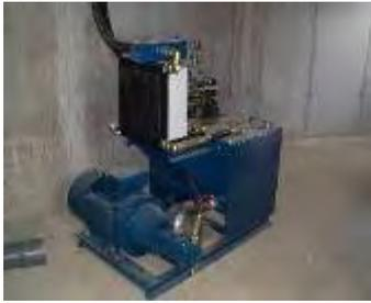
Abbildung 6: Zentrales Hydraulikaggregat
