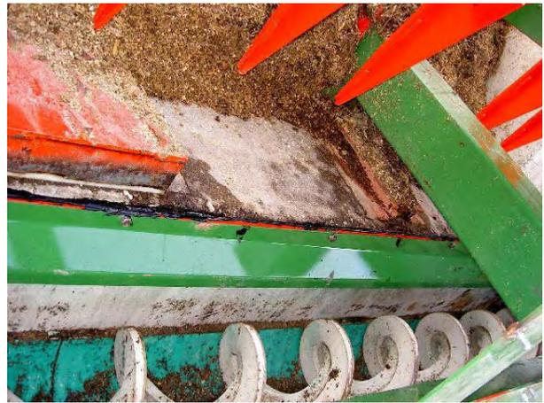
Abbildung 27: Einbau der Querschnelle und Anschluss an die Anlagen SPS, Aufbau der Schutzeinhausung und Anbindung der Schnecke über einen Fallschacht an die Mischgrube ( Vorgrube – Aufgrund des hohen Anteiles an Feststoffen entstehen Probleme beim Pumpvorgang in die Fermenter )
