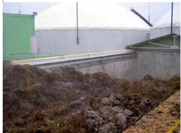
Abbildung 33: Durch ständiges Überfüllen des Feststoffbehälters treten Verunreinigungen an den Führungsschienen und an der Antriebseinheit des Schubdaches auf. Durch diese Verschmutzung wurde auch die Seilführung mehrmals komplett verklemt.
