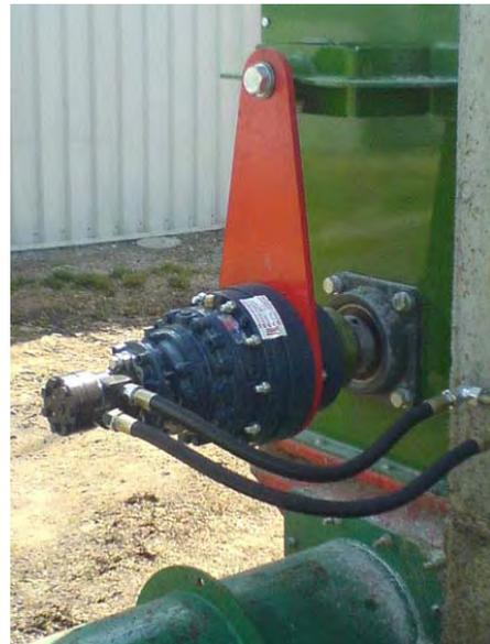
Abbildung 39: Hydraulischer Antrieb Dosierwalze mit Planetengetriebe und Drehmomentstütze
