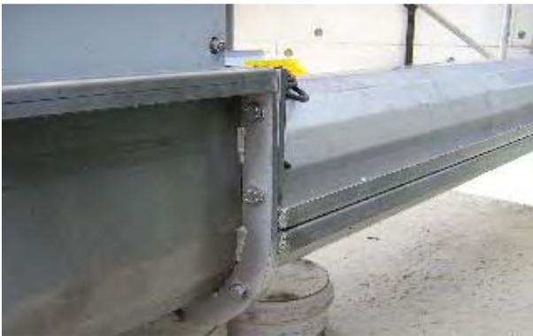
Abbildung 42: geflanschter Scheckentrog mit Serviceöffnung
