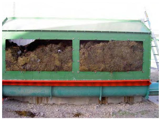
Abbildung 29: Mehrmaliger Bruch der Schubstangen und der Schieber, Starker Verschleiß bei allen mechanischen Bauteilen, da mit hohem Hydraulikdruck gearbeitet werden musste, um den Reibungswiderstand am Betonboden bzw. an den Seitenwänden zu überbrücken. Da es sich bei Grassilage um kein rieselfähiges Substrat handelt, traten starke Brückenbildungen an der Querförderschnecke auf.
