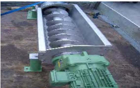
Abbildung 44: Übergabestation von Schubboden in Querförderschnecke
