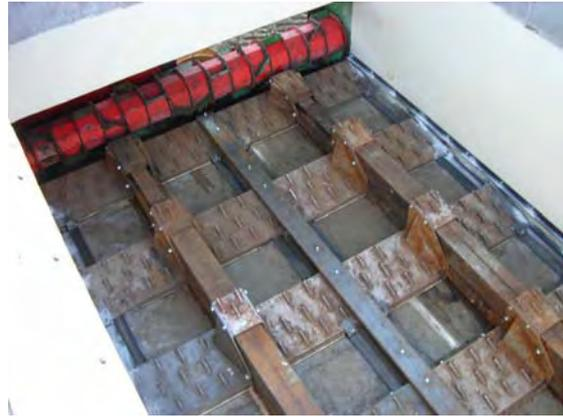
Abbildung 36: Kompletter Umbau des Schubbodens mit Seitenführungen und Niederhaltern. Austausch der Schubelemente und der Schubstange. Anstrich der Bodenplatte und der Seitenwände mit speziellem Anstrich durch den Anlagenbetreiber.
