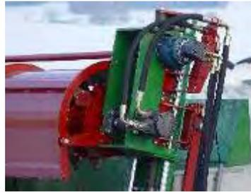
Abbildung 7: Hydraulischer Fräsantrieb und Fräsvorschub
