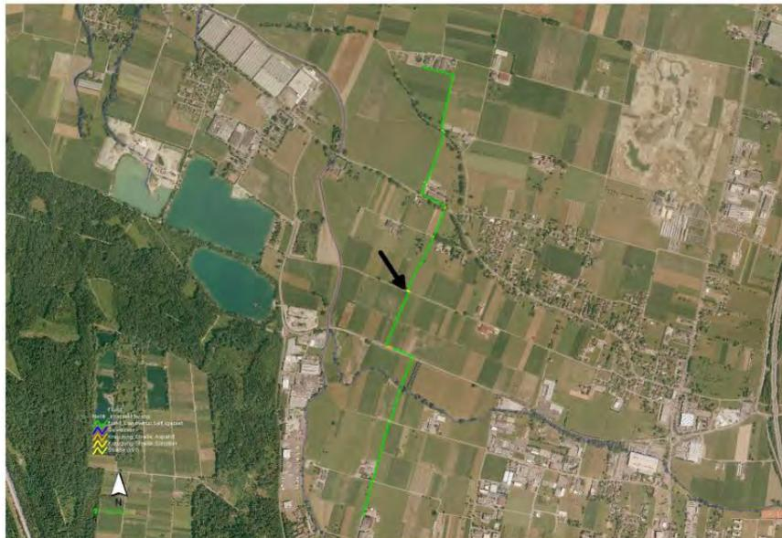
**Abbildung 19: Darstellung der Rohgasleitung in der Region Feldkirch-Rankweil, welche drei Anlagen verbindet. Der Pfeil zeigt den Einspeisepunkt.**
