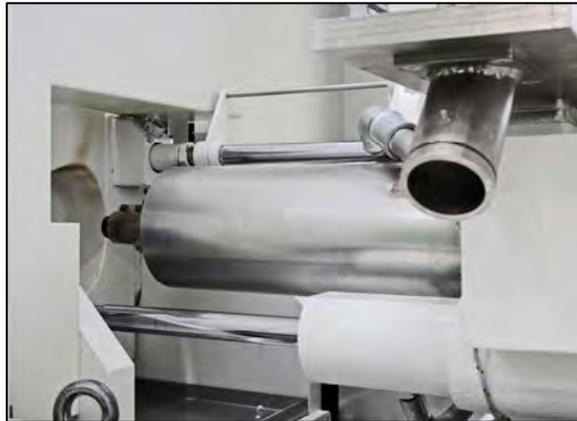
Abbildung 31: Einhausung des Plastifizierzylinders
