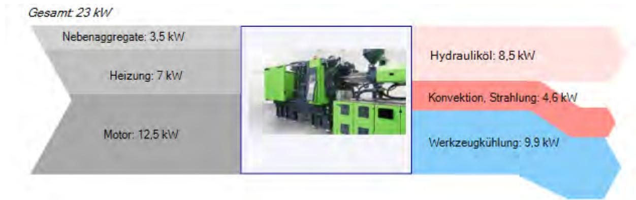
Abbildung 13: Sankey Energieflussdiagramm
